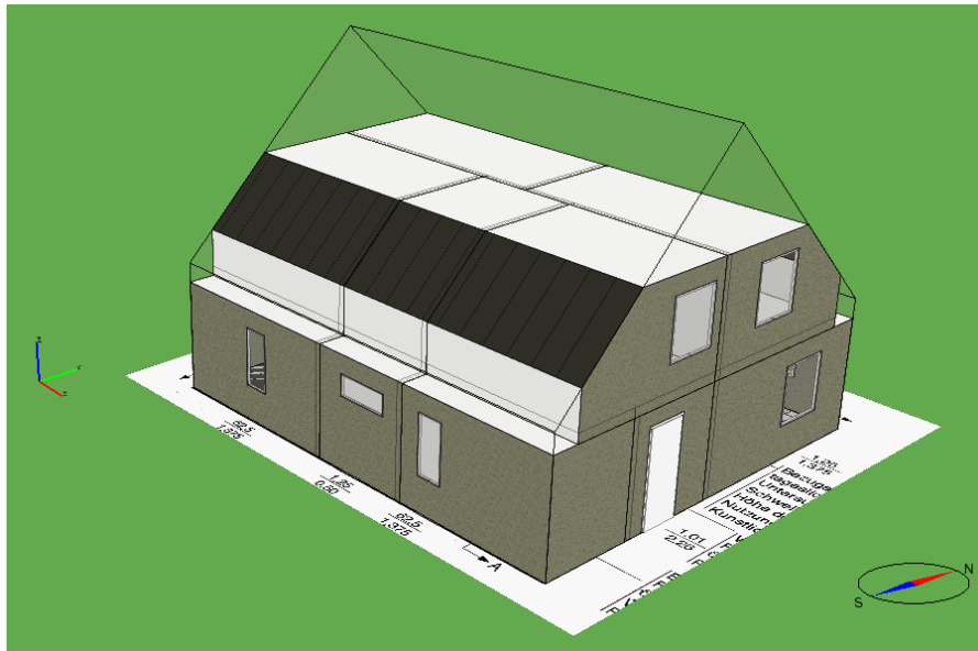
Abbildung 21: Skizze des Basismodells zur Validation der BPO aus IDA ICE, U_W = 1,3 \text{ W/m}^2\text{K} , U_{AW} = 0,28 \text{ W/m}^2\text{K} , U_D = 0,20 \text{ W/m}^2\text{K} , U_{KD} = 0,35 \text{ W/m}^2\text{K} , H'_T = 0,40 \text{ W/m}^2\text{K}
