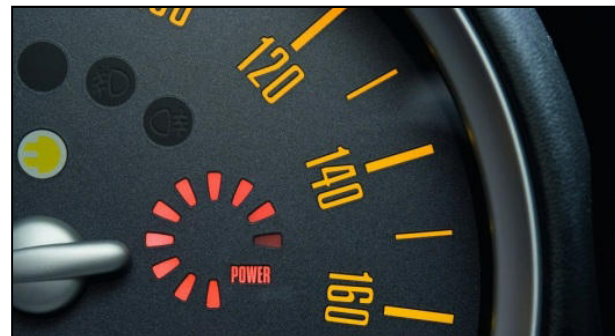
Abbildung 4-2: Powermeter zur Anzeige der Leistungsabgabe der E-Maschine (horizontaler Strich links = Leerlauf; im Uhrzeigersinn = Leistungsabgabe; gegen den Uhrzeigersinn = Rekuperation; BMW Group, 2012)
