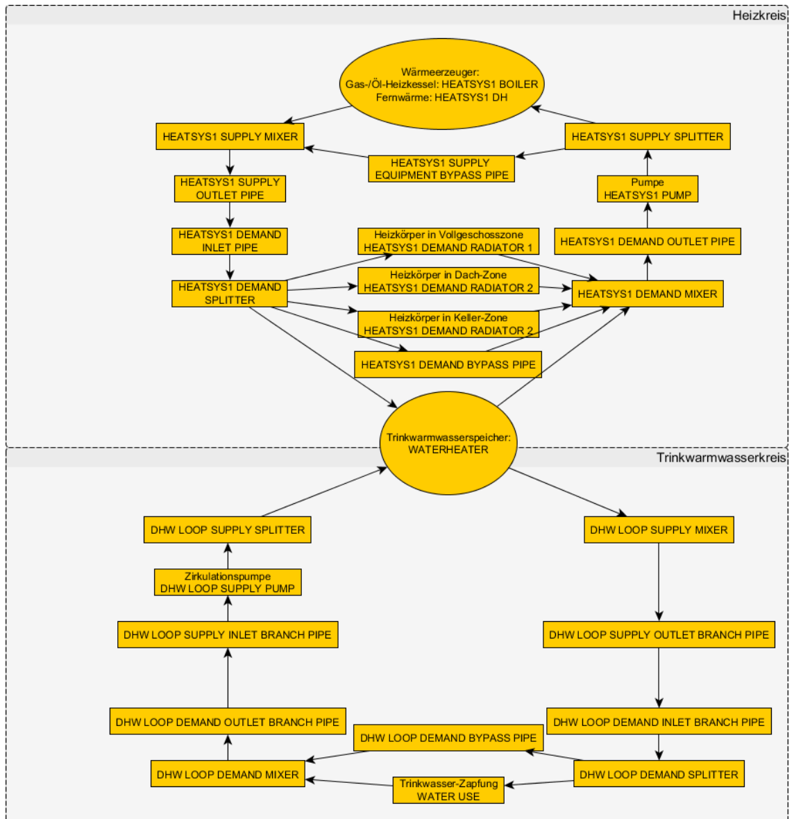
Abbildung C.1.: Heizungsschema mit Heizkessel oder Fernwärmeübergabestation, ohne Solarthermieunterstützung
