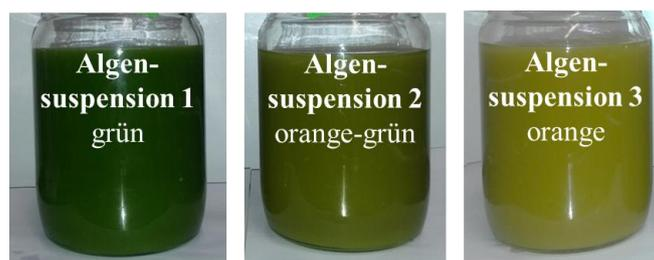
**Abbildung 5-10:** Unterschiedlich pigmentierte Mikroalgenkulturen (*Scenedesmus obtusiusculus*) zur Charakterisierung des Einflusses der Zellzusammensetzung auf die Lichtabsorption im Flachplattenphotobioreaktor.
