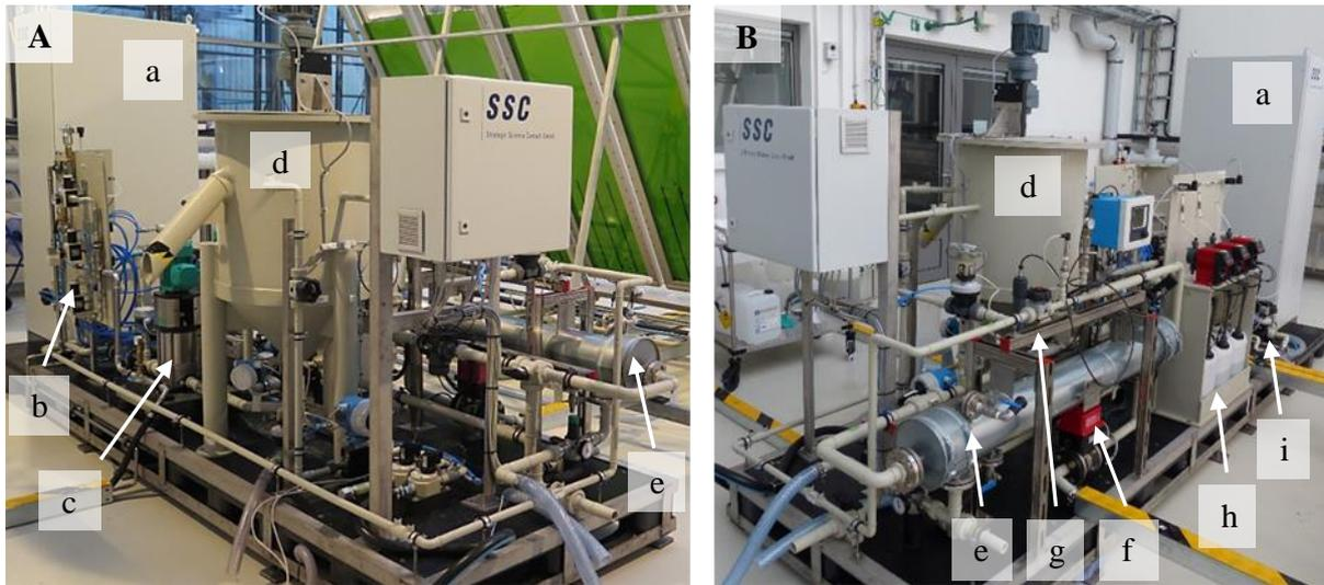
**Abbildung 4-12:** Überblick über die Prozesseinheit des Flachplattenphotobioreaktors im Pilotmaßstab. **A:** Rückansicht. **B:** Frontansicht.
