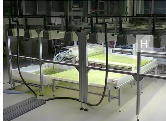
**Abbildung 4-8:** Schematischer Aufbau (links) und photographische Abbildung (rechts) des *Flaches Schrägerinnes* zur Herstellung des Hauptinokulums für Satzprozesse im 300 L-Flachplattenphotobioreaktor.
