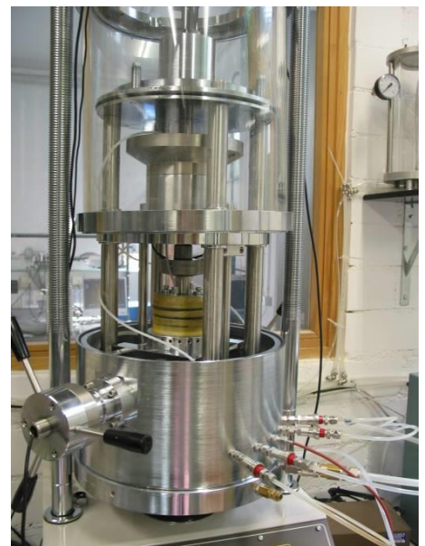
Abbildung 4.22: Übersicht der beiden Triaxialanlagen mit Zellen, Lastrahmen und Drucksystem
