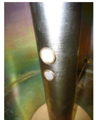
Abbildung 4.47: Frontmembransensor zur Messung der totalen Spannungen (links); Einsatz des Frontmembransensors und Filterelement zur Messung des Porenwasserdruckes (Mitte und rechts)
