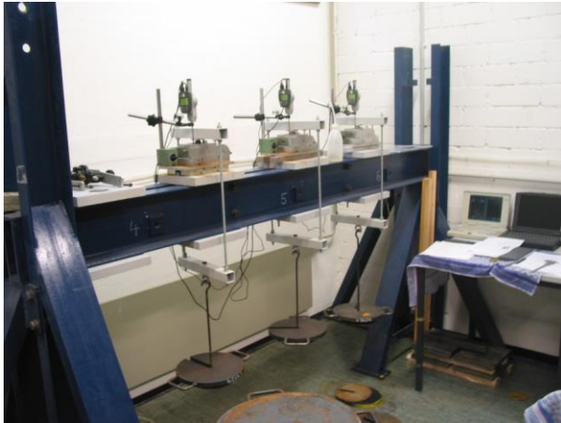
Abbildung 4.5: Ödometerversuche mit inkrementeller Laständerung
