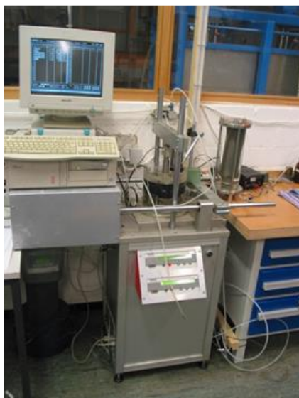
Abbildung 4.6: Versuchstechnik zur Durchführung vorschubgesteuerter Ödometerversuche
