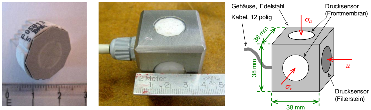
Abbildung 4.8: Spannungssensor zur Messung von \sigma_a , \sigma_r und u
