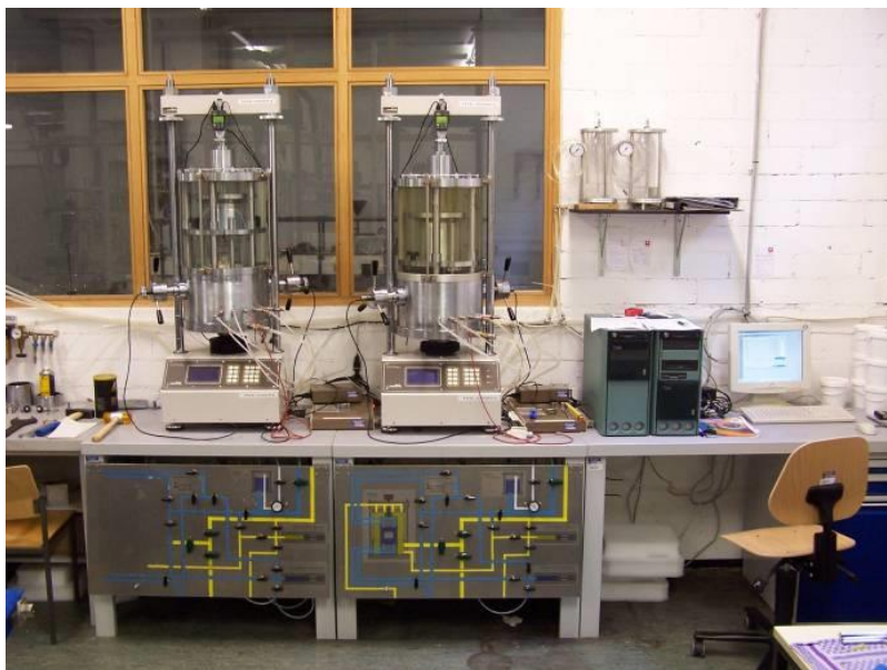
Abbildung 4.22: Übersicht der beiden Triaxialanlagen mit Zellen, Lastrahmen und Drucksystem
