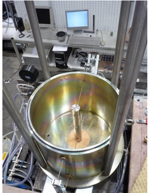
Abbildung 4.43: Gesamtansicht der Versuchsanlage (links); unterer Ring des Behälters mit eingestelltem Modellpfahlsegment (rechts)
