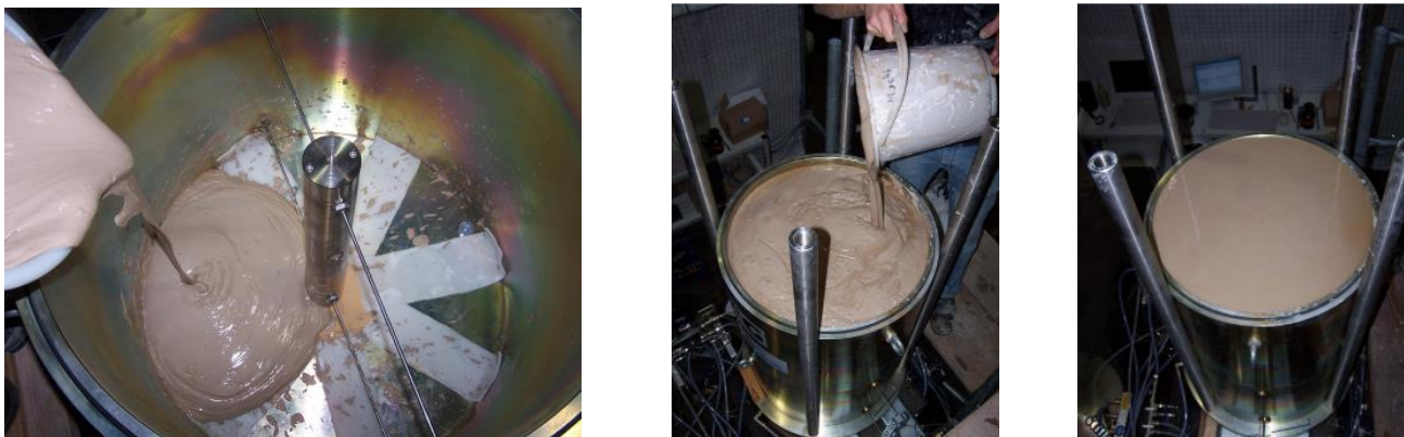
Abbildung 4.48: Einfüllen des flüssigen Versuchsboden
