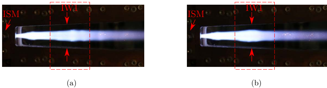
Abb. 7.6: Aufnahmen der Reaktionszone (a) vor und (b) nach Zustandsänderung bei zweistufigem Betrieb, mit Markierung der Injektionspositionen
