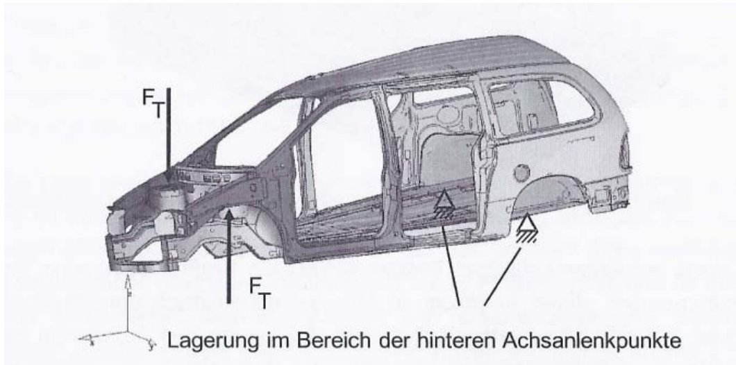
Abbildung 4.6: Verformung einer Karosserie bei Torsionsbelastung. [10]
