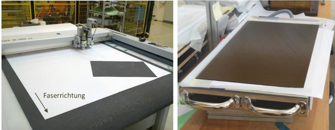
**Abb. 2-3: CNC-Schneiden der Prepreg-Lagen und Lagenablage vor der Konsolidierung.**
