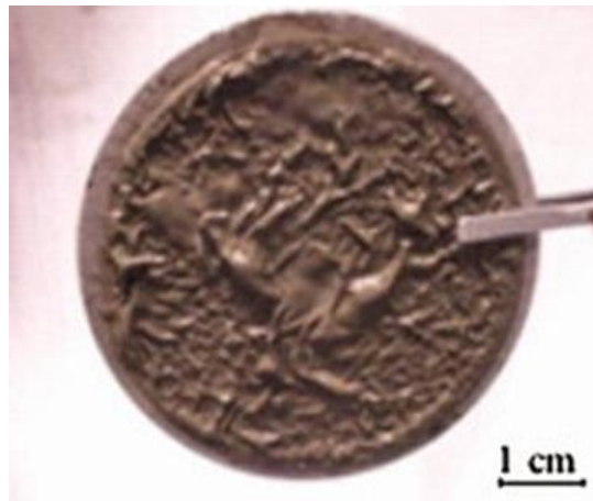
Abbildung 16: Polymerfilm zwischen Zementfilterkuchen und Maschensieb; erhalten nach Druckfiltration einer Zementschlämme bei 70 bar mit einer PVA-Dosierung von 0.5 % bwoc [89].
