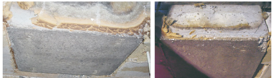
Bild 3. Kleinprobekörper mit 2,0 kg/m 3 PP-Fasern direkt nach dem Brandversuch
