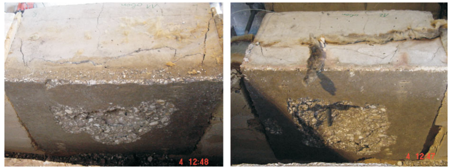
Bild 2. Kleinprobekörper mit 0 kg/m 3 PP-Fasern direkt nach dem Brandversuch
