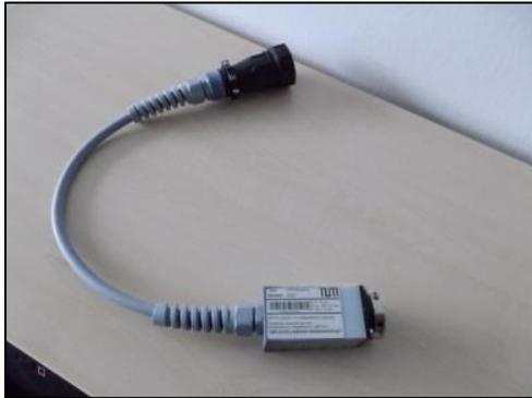
Abbildung 22: ap-pa-Switch zur Umkehr der Stromflussrichtung
