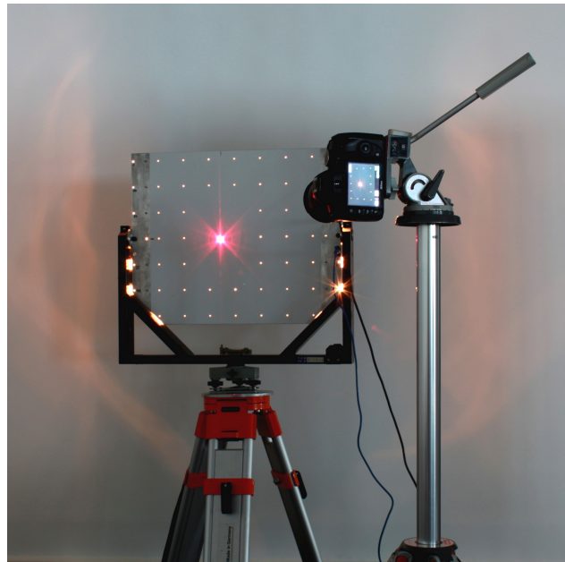
Abbildung 5.10: Messkonfiguration für die indirekte Laserabbildung über eine Projektionstafel
