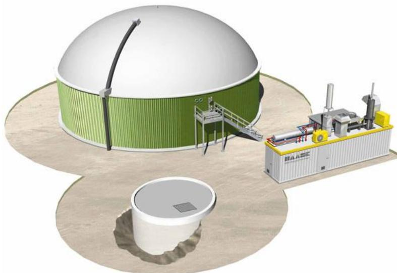
Abbildung 2.7: Aufbau eines Biogaskraftwerks (Quelle: HAASE Energietechnik GmbH)
