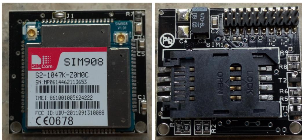
(a) SIM908-Modul mit Antennenbuchsen (b) SIM908-Modul-Rückseite mit SIM-Kartenhalter
