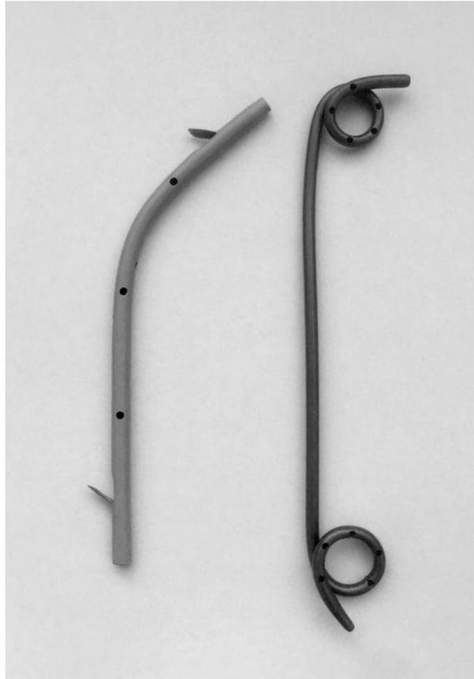
**Abb. 1:** Stentdesign. Links: Gebogener Stent mit Seitenöffnungen, Durchmesser 10 Fr., Länge 6 cm (Polyethylen, Peter Pflugbeil GmbH, Deutschland). Rechts: Pigtailstent mit Seitenöffnungen, Durchmesser 7 Fr., Länge 7 cm (Polyethylen, Cook, Irland).
