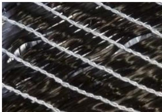
Abb. 7.17: Fehlerbild von Mäandern in einem bidiagonalen MAG (+45 ° / -45 °)
