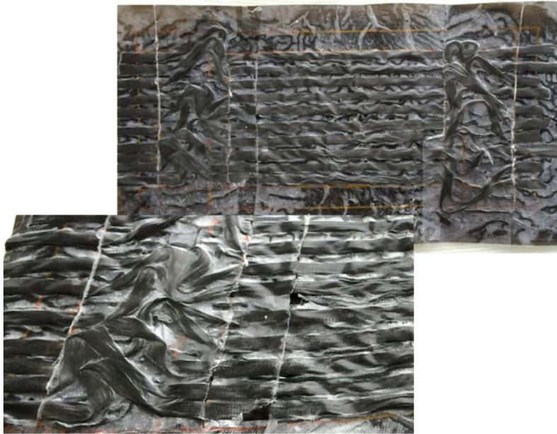
**Abb. 7.40: Carbonrovings zwischen TP Folien von EMS und LANXESS mit Fadenreserven**
