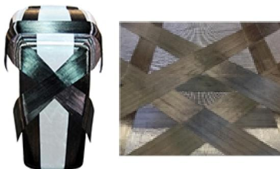
**Abb. 3.2: Lastoptimierte Faserarchitektur und maßgeschneidertes Halbzeug [Compositence]**
