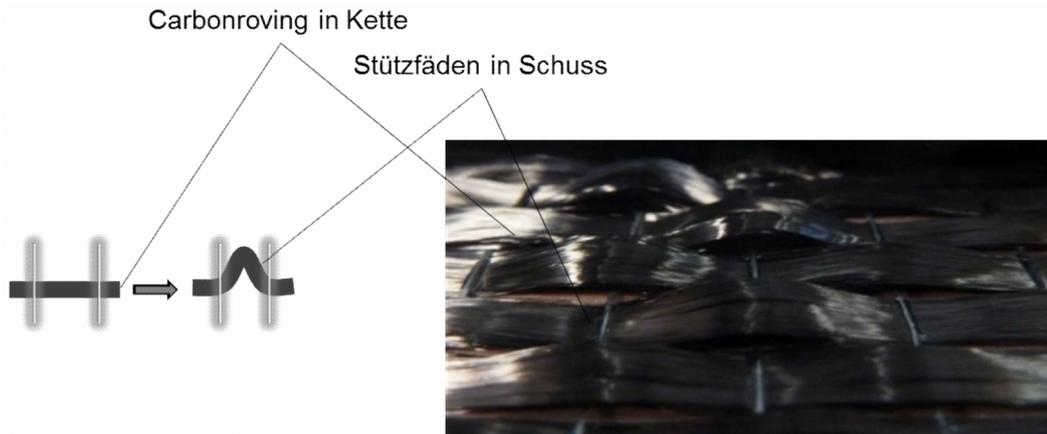
Abb. 7.16: Skizze (links) und Fehlerbild (rechts) von Schlaufen in einem unidirektionalen Gewebe
