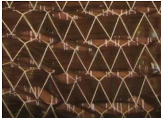
Abb. 7.14: Fehlerbild von Gaps in einem unidirektionalen MAG
