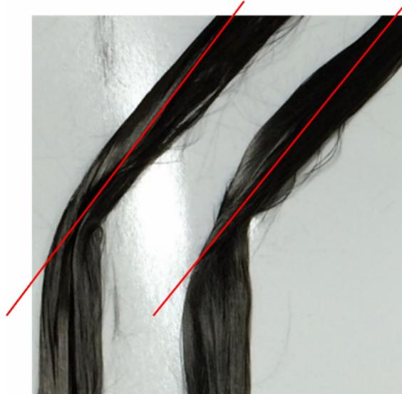
**Abb. 4.34: Filamentverlauf bei 45 °-Richtungsänderung eines GRAFIL- (links) und SIGRAFIL (rechts)-Rovings**
