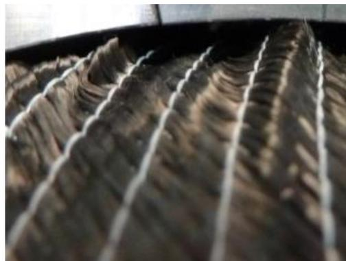
Abb. 7.15: Fehlerbild von Wellen in einem bidiagonalen MAG (+45 ° / -45 °)
