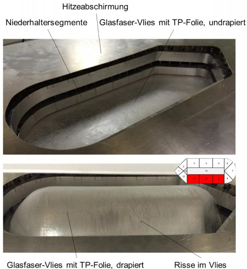
**Abb. 4.27: Drapierung von Glasfaservlies mit TP-Folie von EMS Chemie unter Temperatur**
