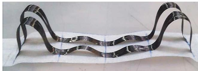
**Abb. 4.14: Fadenreserven in z-Richtung mit unterschiedlichen Schlaufenhöhen zur Drapierung einer Halbkugel**
