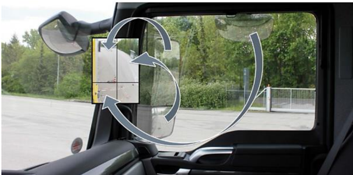
Abbildung 5-10: Hauptaußen-, Weitwinkel- und Anfahrspiegel werden in kombinierter Ansicht dargestellt (Zaindl et al., 2015)
