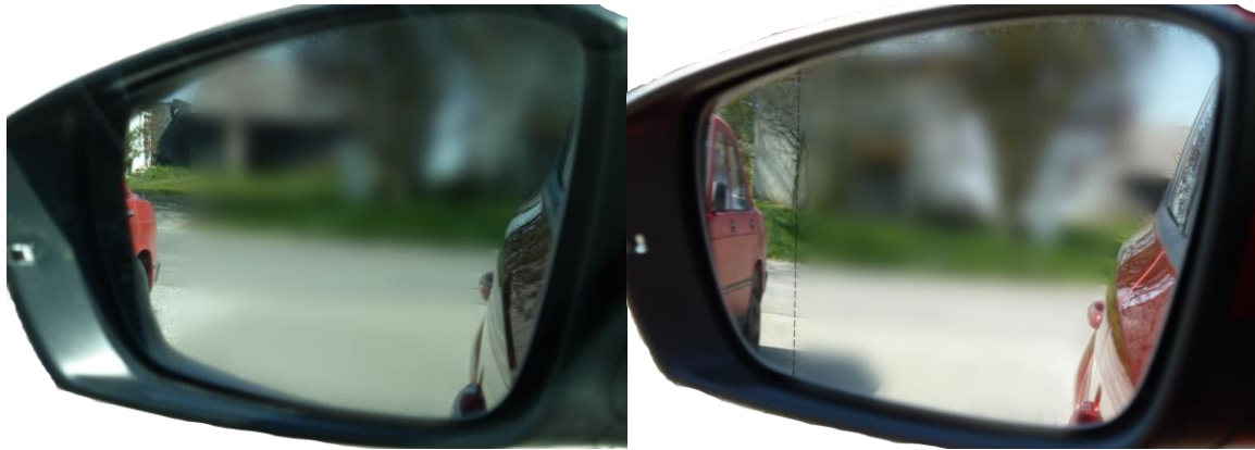
Abbildung 2-3: Vergleich von Pkw-Spiegel ohne und mit asphärischem Bereich
