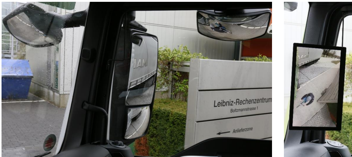
Abbildung 6-5: direkter Vergleich zwischen Spiegelsystem und KMS in der Rangieransicht: Beim Rechtsabbiegen befindet sich ein Radfahrer direkt an der vorderen rechten Ecke des Lkw
