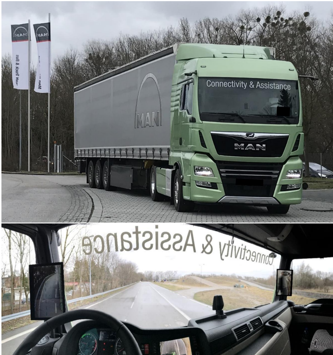
Abbildung 5-8: Prototyp des Spiegelsatzsystems von außen und innen
