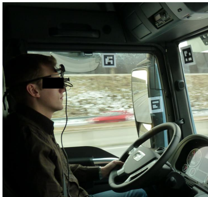
Abbildung 4-5: Fahrversuch mit Blickerfassung (verwendetes System: Dikablis)
