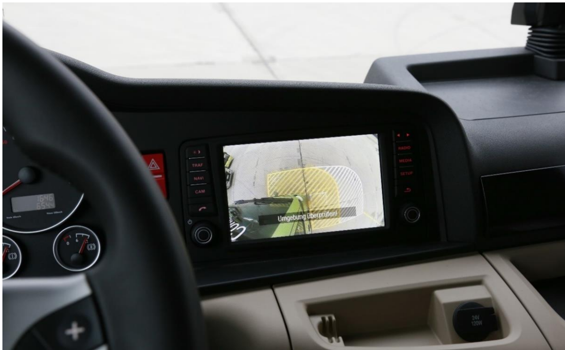
Abbildung 5-14: Anzeige des Frontbereiches im Display des Infotainmentsystems. Bei dieser Art der Darstellung wird der komplette Anfahrbereich aus Front- und Anfahrspiegel angezeigt
