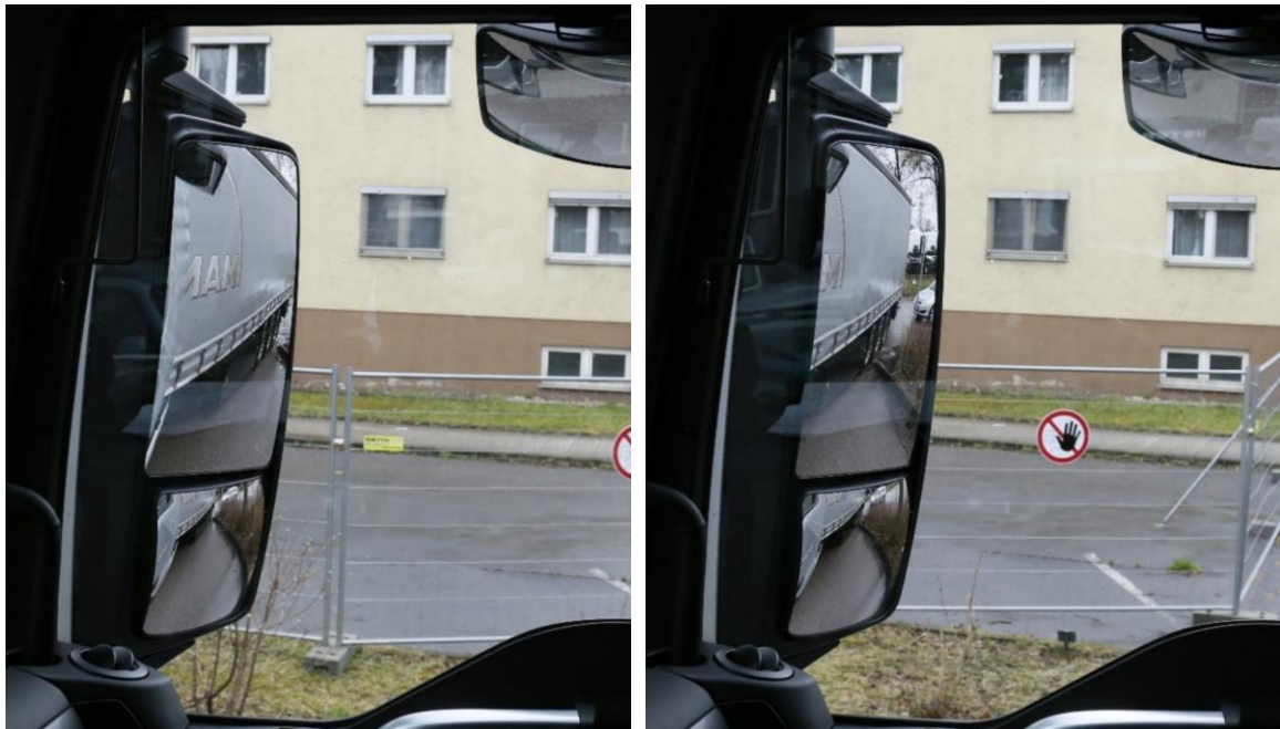
Abbildung 4-8: Durch eine Kopfbewegung kann der Fahrer im Hauptspiegel das Trailerende erkennen. Links: Das Trailerende und der rückwärtige Verkehr ist im Hauptspiegel nicht zu erkennen. Rechts: Verbesserung der Sichtsituation durch eine Kopfbewegung (der Effekt wurde während der Fahrt mithilfe der Spiegelverstellung simuliert. Kameraposition blieb fix)
