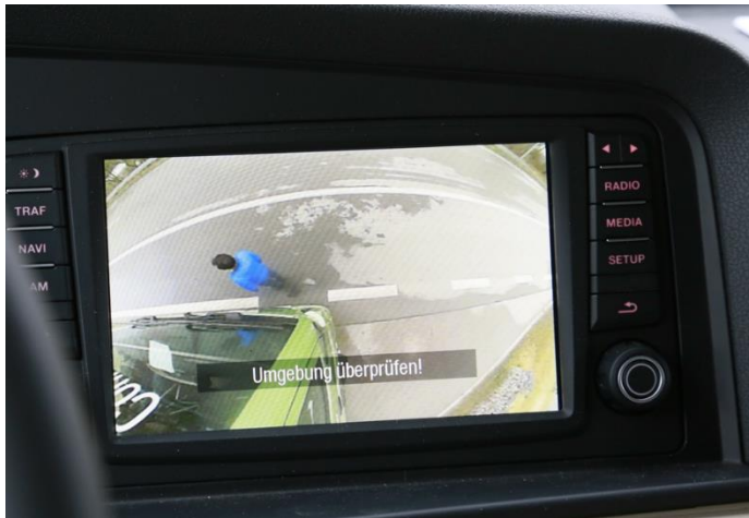
Abbildung 5-15: Vergleich Frontspiegeleratz mit aktuellem Frontspiegel
