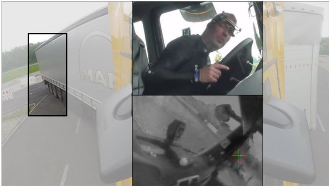
Abbildung 4-13: Visualisierung des vom Fahrer eingesehenen Bereiches – der Fahrer nimmt über den Hauptspiegel nur einen kleinen Teil seiner Umgebung wahr (qualitative Darstellung)
