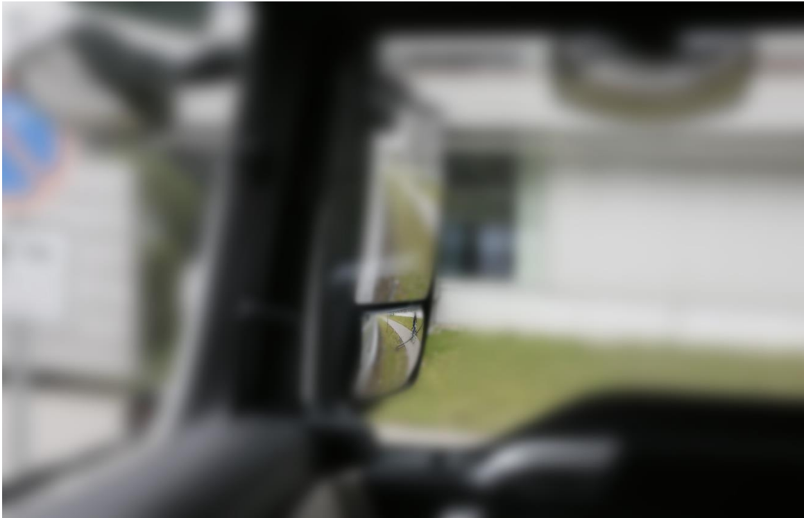
Abbildung 3-13: Fovealer Blick in den Spiegel – erst beim direkten Blick in den Weitwinkelspiegel ist der Radfahrer erkennbar. Beim ersten Blick in den Hauptspiegel bleibt er unentdeckt (siehe Abbildung 3-12)
