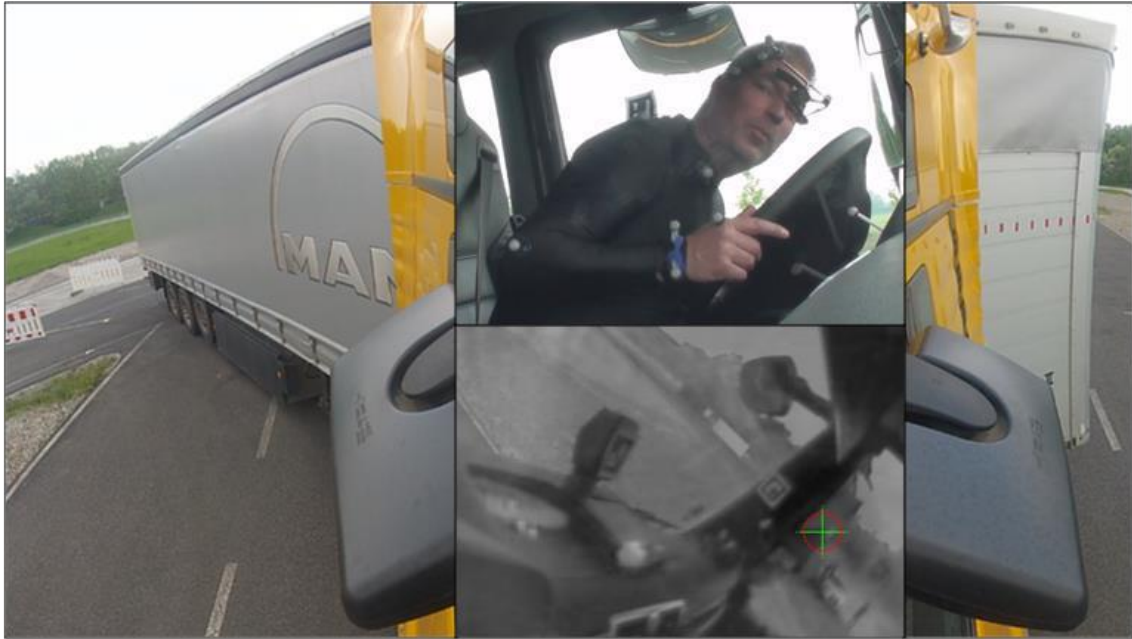
Abbildung 4-12: Blick in Versuch – der Fahrer rangiert um 90° in eine Parklücke, die sich auf der Beifahrerseite befindet. Er blickt in den Hauptspiegel und beugt sich dabei weit nach vorne (Graf, 2014)
