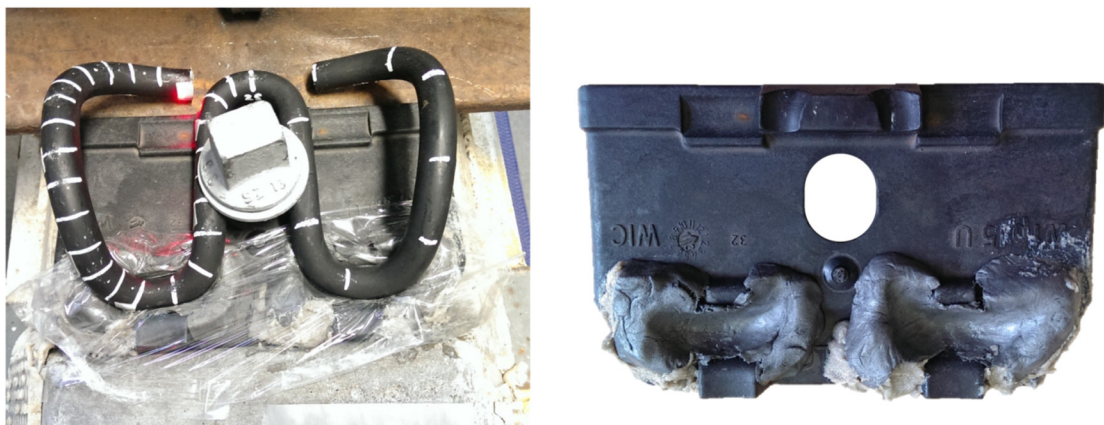
Abbildung 6.22 Prototyp einer formmodifizierten Winkelführungsplatte
