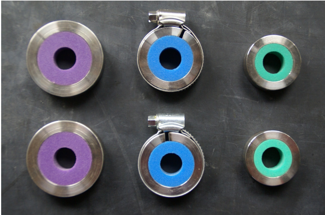
Abbildung 6.12 Prototypen ringförmiger Schwingungstilger: R3, R2 modif , R1 (v.l.n.r.)
