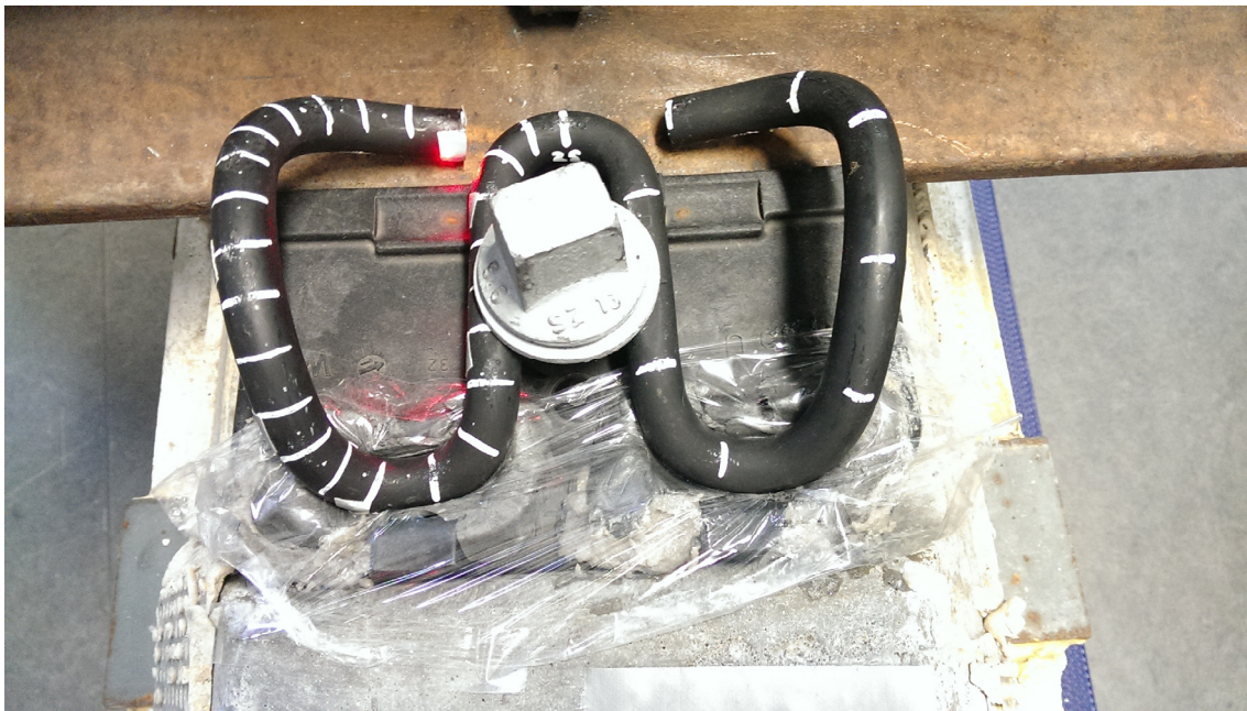
Formmodifizierte Winkelführungsplatte - Experimentelle Modalanalyse mit Laservibrometer
