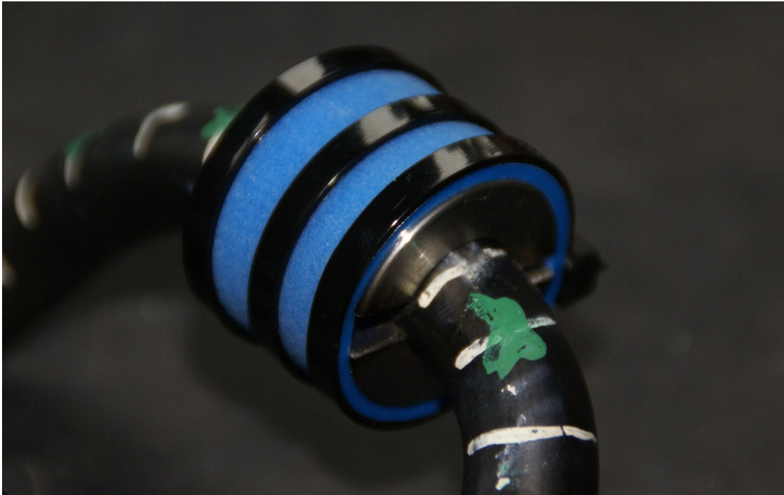
Abbildung 6.13 Prototyp des schlauchförmigen Schwingungstilgers S1 mit innenliegender Masse Die Massen aller Bauteile wurden vor den Messungen gewogen und sind in Anlage 4.3 tabellarisch zusammengefasst.
