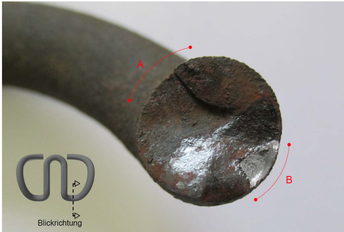
Abbildung 8.5 Bruchfläche eines abgebrochenen Federarms
