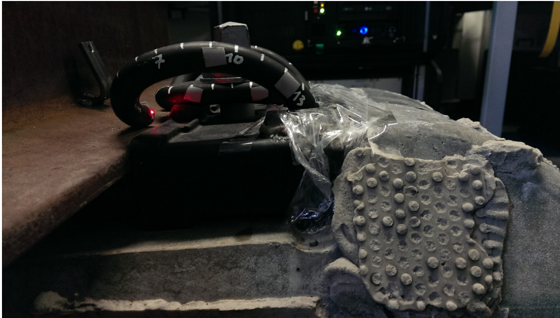
Formmodifizierte Winkelführungsplatte - Experimentelle Modalanalyse mit Laservibrometer
