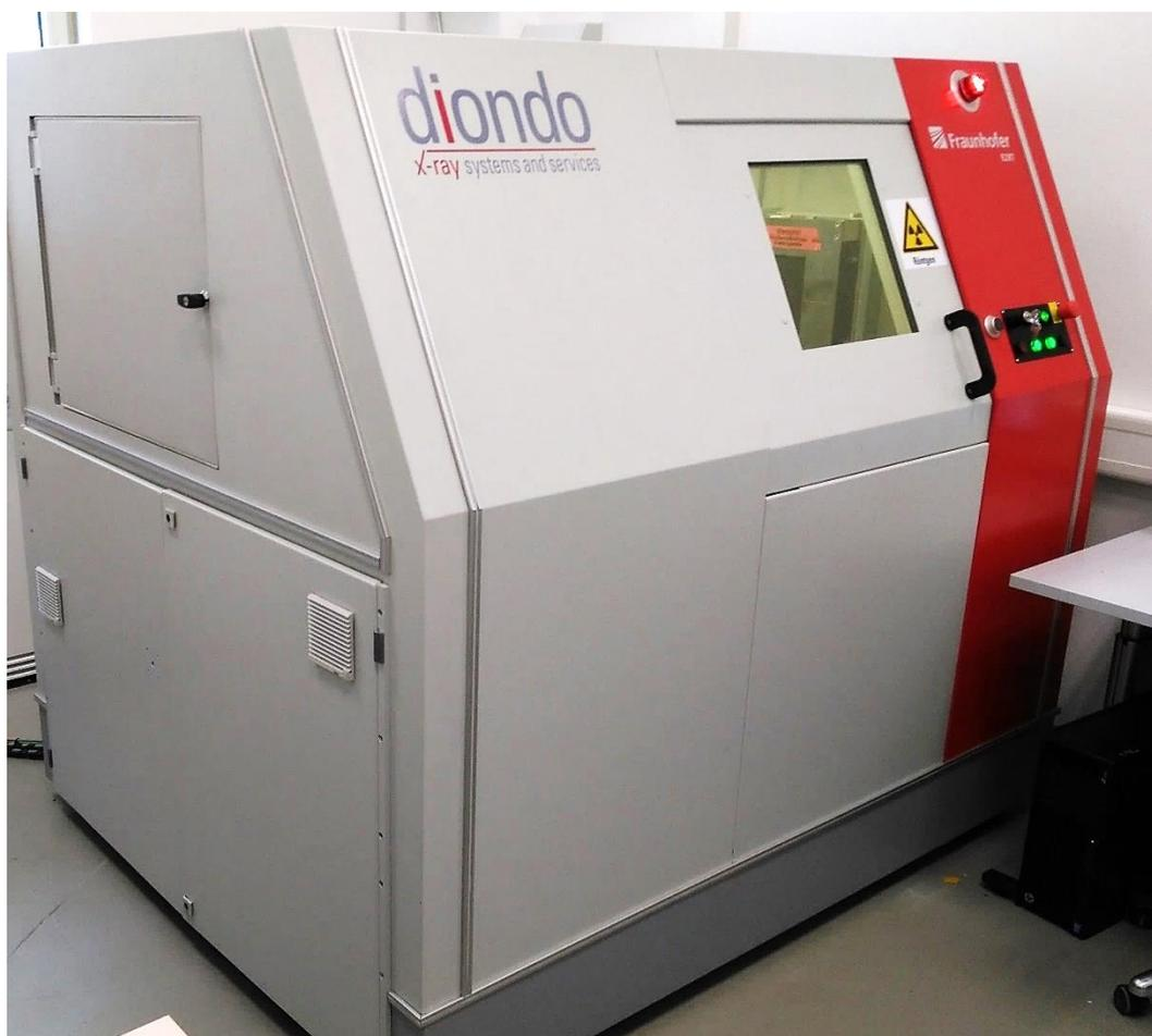
*Abbildung 8.1: RayScan 150 CT-System des Herstellers RayScan Technologies, welches im Jahr 2015 durch das Fraunhofer EZRT und Diondo modernisiert wurde.*
