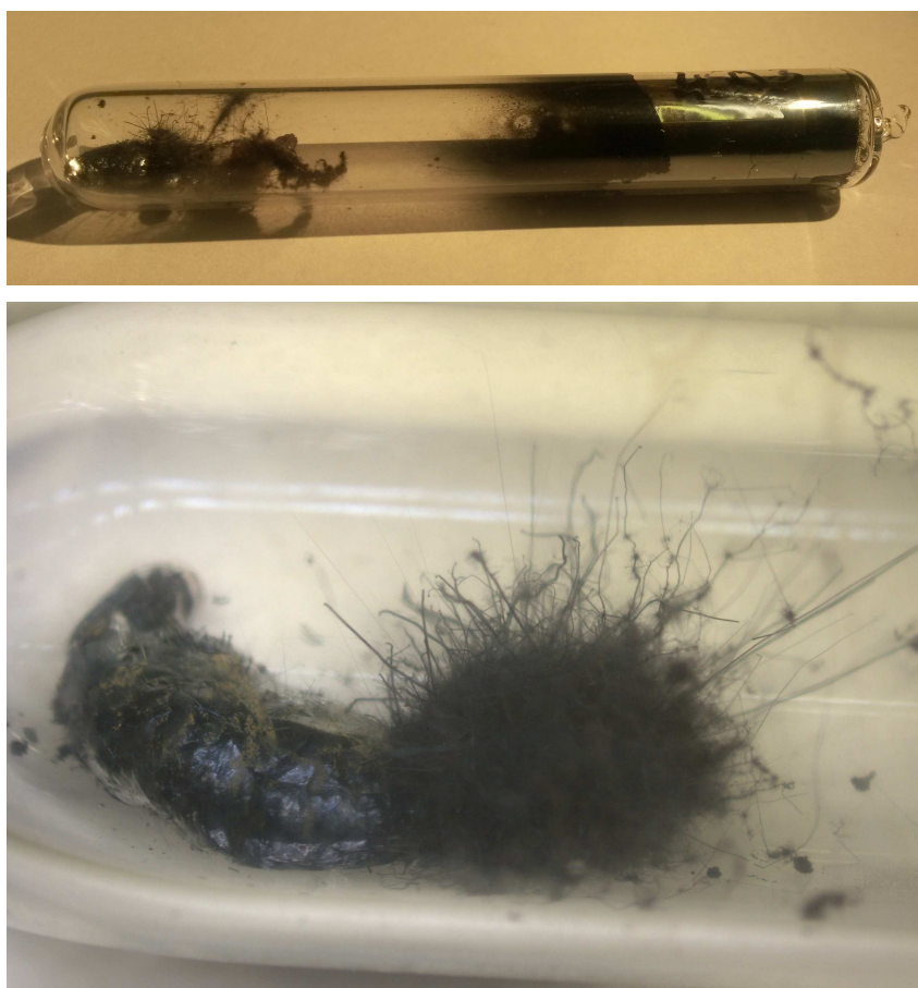
Abbildung 7.1.: Synthese von P_{20,56}Sb_{0,44} . Oben: Ampulle nach der Reaktion. Auf der linken Ampullenseite befindet sich der Bleischmelzregulus. Unten: Bleischmelzregulus mit aufgewachsenem P_{20,56}Sb_{0,44} [219].
