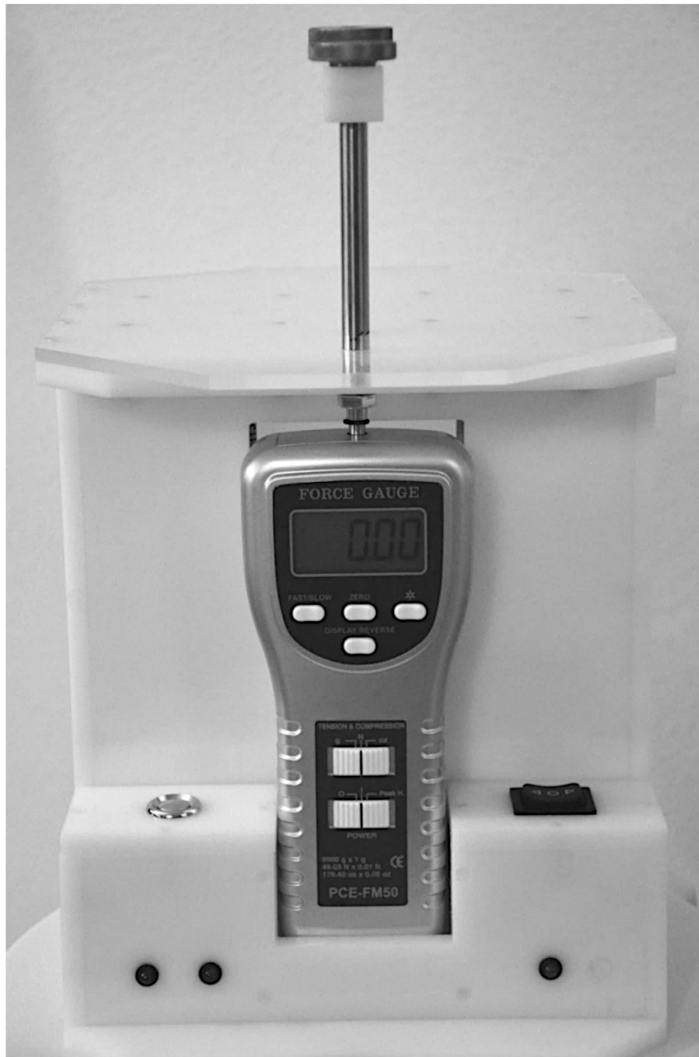
Abbildung 4 Mess-Station mit integriertem Kraftmessgerät
