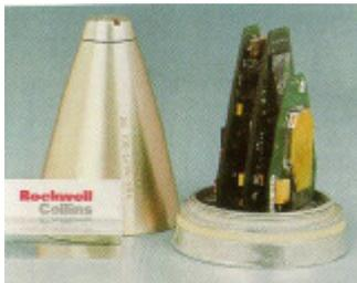
Abbildung 5.18: Y-Code-GPS-Empfänger von Rockwell für Artilleriemunition
