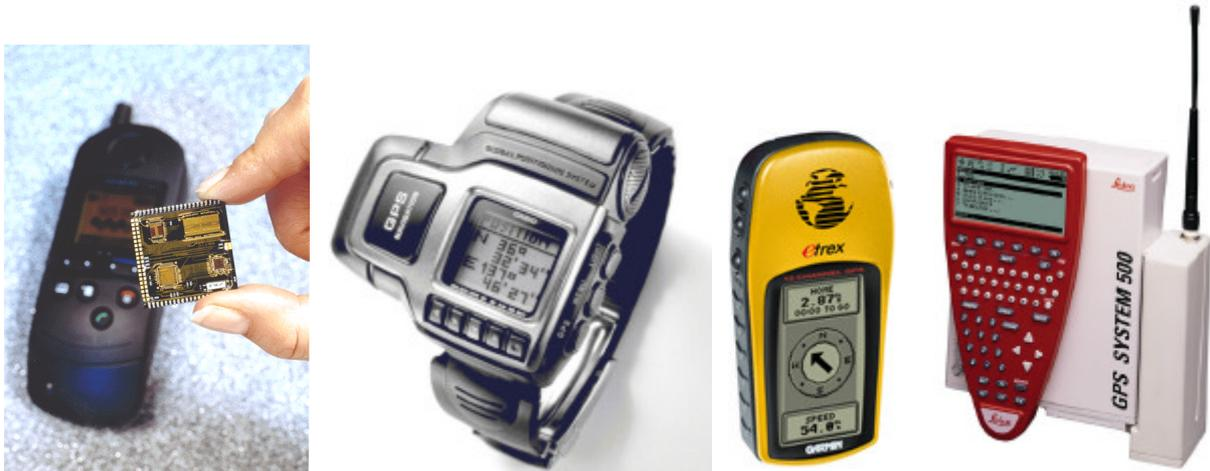
Abbildung 5.10: GPS/DGPS-Chip der Firma µBlox, GPS-Uhr von Casio, Handheld GPS/DGPS-Empfänger von Garmin und das RTK-fähige geodätische Zweifrequenz-System mit integriertem Datenfunk von Leica (v.l.n.r.)
