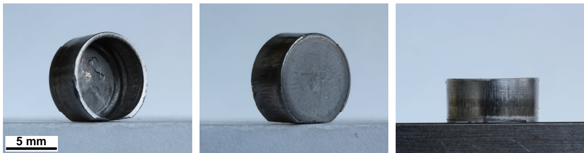
Abbildung 9.7: Mit HG-Pressen umgeformter Napf, Versuchswerkstoff 100Cr6, RT, \varphi_m = 3,1 (verschiedene Ansichten; Napf wurde nach der Umformung auf einer Seite spannd bearbeitet)
