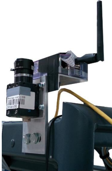
Abbildung 5-15: Schraubhalterung am Heck der Fahrerkabine (Anbringungspunkt ID01 [GÜN-2014a, S. 39])
