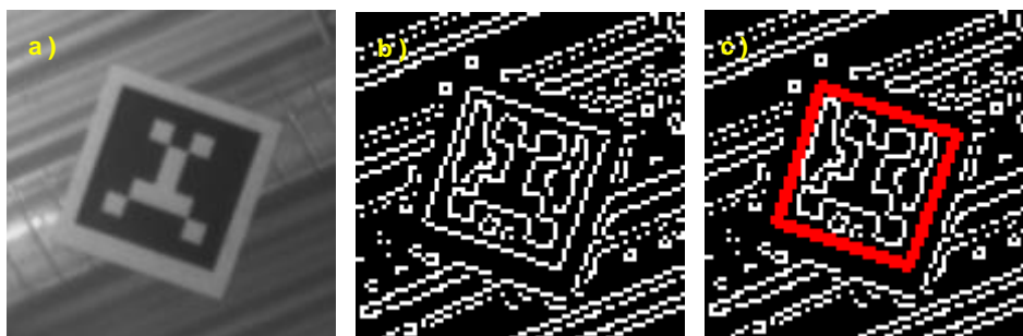
Abbildung 2-1: Phasen der Extraktion eines Fiducials [HIR-2008, S. 2ff.; GAR-2014; MUN-2014]
