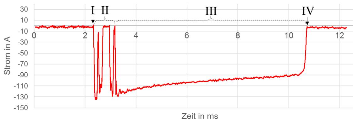
Abbildung 6.16: Auslöseverhalten LBS 310-7-1, Breite b=0,3 \text{ mm}
