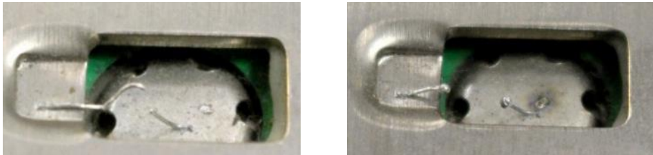
Abbildung 6.25: Bondingdraht, ausgelöst bei I = 20 \text{ A}
