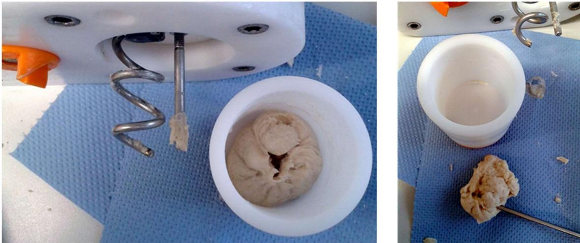
**Abbildung 3.27: Zustand des Teiges nach dem Anteigen im Spiralkneter**
