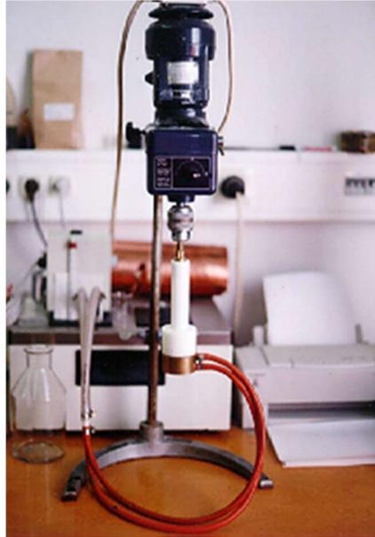
**Abbildung 3.35: Mikro-Rapid-Mix-Test (MRMT)-Knetter**
