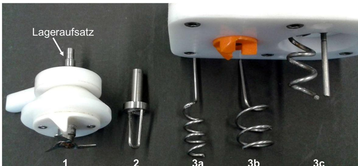
**Abbildung 3.24: Unterschiedliche Geometrien für den Mikrokneter**
