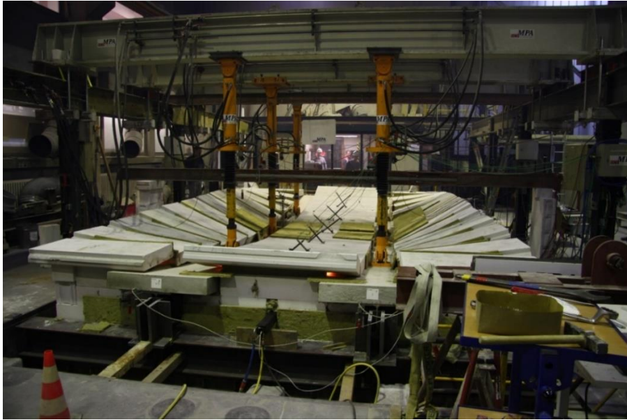
Bild 14: Prüfaufbau während der Beflammung
