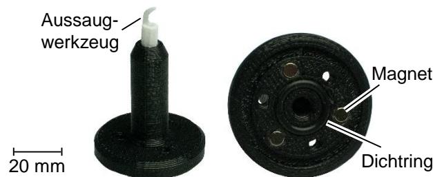
Abbildung 5-10: Halter mit Magneten sowie angebrachtem Aussaugwerkzeug (gebogene Spitze zur Erzeugung von Kanälen)
