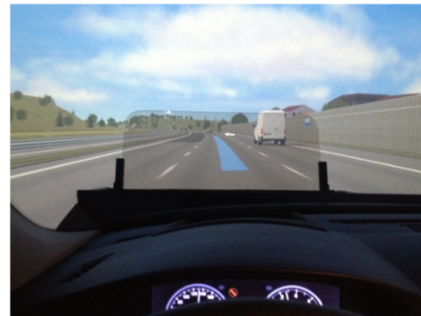
Konzept: „Balken“ Markierung in der Mitte des Fahrstreifens
