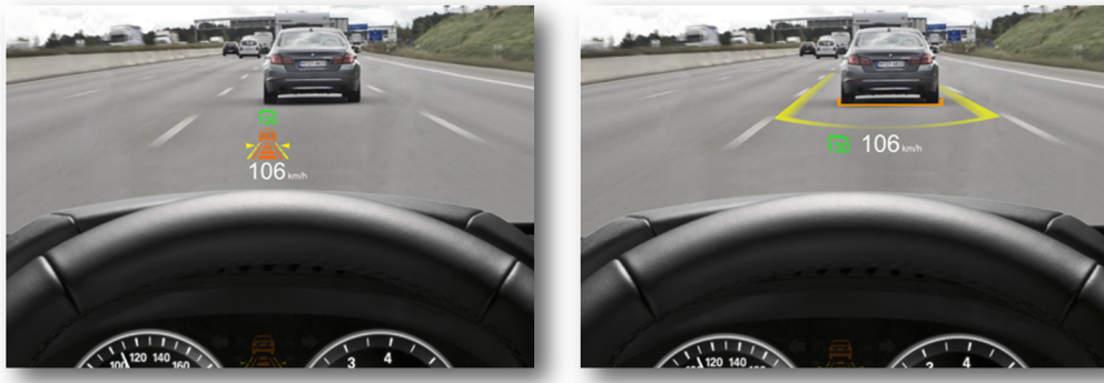
Abbildung 2.44.: Vergleich zwischen klassischen (links) und kontaktanalogen (rechts) HUD-Anzeigen (BMW AG)
