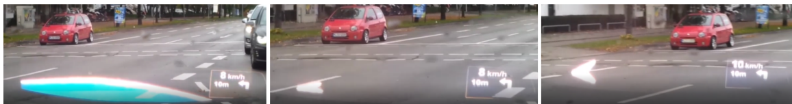
Abbildung 7.54.: Animierter Übergang von Manöverimpuls zu Richtungspfeil
