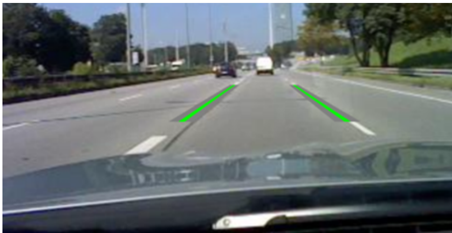
Abbildung 7.42.: Künstliche Überlagerung der Fahrstreifenmarkierungen auf Basis der Kamera-Erkennung als Testdarstellung
