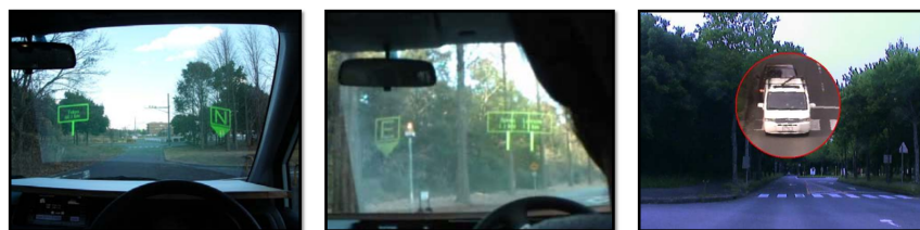
Abbildung 2.14.: AR-Anzeigen im Windschutzscheiben-HUD: Navigationsanzeigen sowie virtueller Rückspiegel [116] [86]
