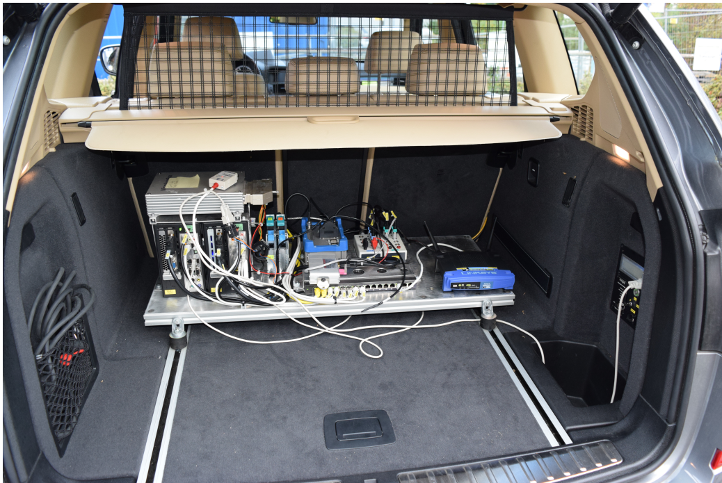
Abbildung 7.21.: Blick auf die CORONA-Plattform im Kofferraum des „PaCo“.
