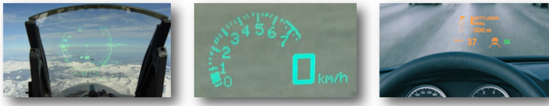
Abbildung 2.33.: Beispiele für Head-up-Displays: Frontscheibenprojektor in Kampfflugzeugen (links), erstes Farb-HUD von Corvette (mittig), HUD-Anzeige aus einem BMW 5er (rechts)
