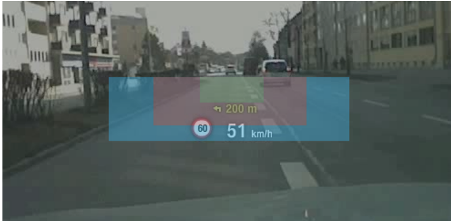
Abbildung 7.12.: Überlagerung mit verschiedenen HUD-Größen: 20^\circ \times 5^\circ in Blau, 12,5^\circ \times 4^\circ in Rot und 8^\circ \times 3^\circ in Grün
