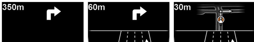
Abbildung 7.24.: Elemente der klassischen Variante: Piktogramm, Fahrstreifenführung, abstrakte Kartendarstellung
