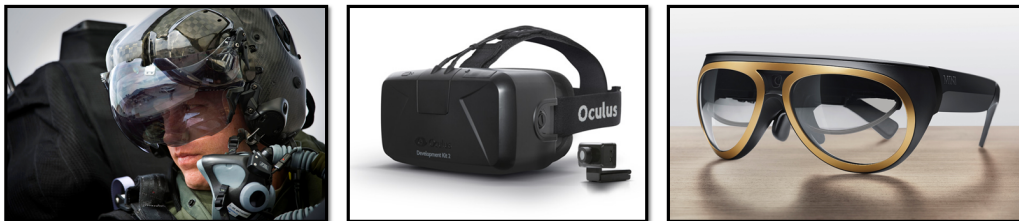
Abbildung 2.3.: Verschiedene HMD-Ausprägungen: Helm-Anzeige, videobasierte und durchsichtige AR-Brille [U.S. Air Force / Oculus VR / BMW AG ]
