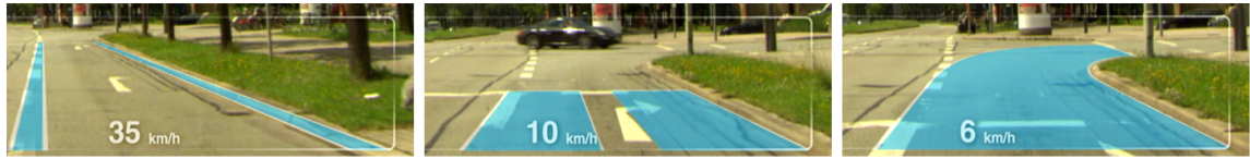
Abbildung 7.7.: Aufbau des Manöverimpulses aus den Fahrstreifenmarkierungen bei Kreuzungsannäherung
