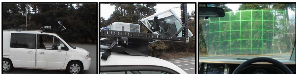
Abbildung 2.47.: Kontaktanaloges HUD mittels Windschutzscheibenprojektion [116]
