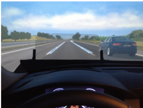
Konzept: „Fahrstreifen“ Markierung entlang der Fahrbahnmarkierung
