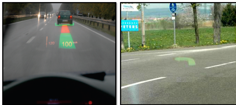
Abbildung 2.13.: Kontaktanaloge ACC- und Navigationsdarstellung [56] [119]
