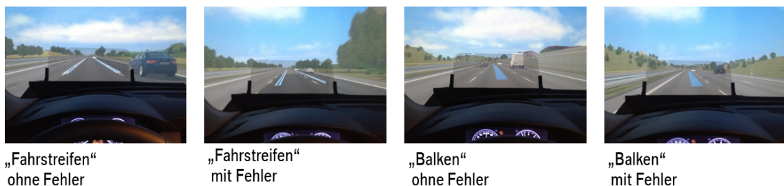
Abbildung 7.33.: Auswirkung einer fehlerhaften Fahrstreifenenerkennung auf die Darstellungsvarianten Fahrstreifen und Balken
