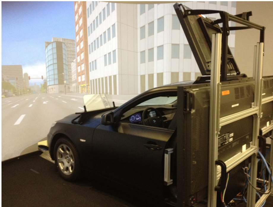
Abbildung 7.16.: Versuchsaufbau im statischen Fahrsimulator mit Sitzkiste
