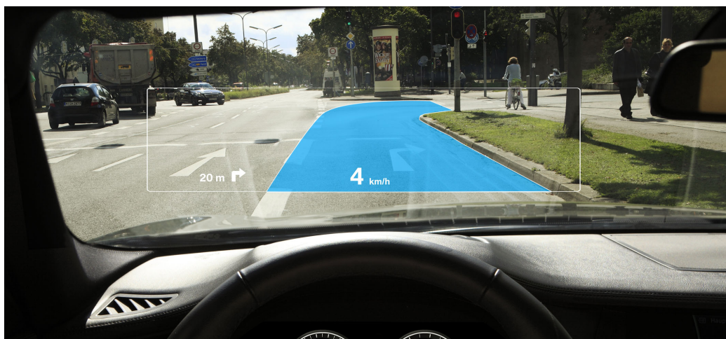
Abbildung 1.3.: Kontaktanaloge Navigationsdarstellung: Die Navigationshinweise verschmelzen mit der Straße
