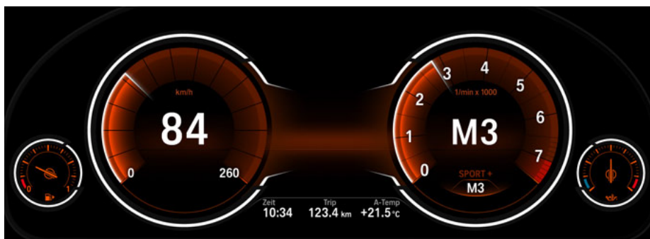
Abbildung 3.3.: Kombi-Instrument mit frei konfigurierbaren Anzeigeflächen (BMW)
