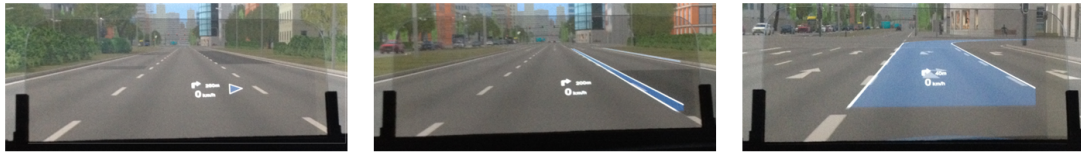
Abbildung 7.25.: Elemente der visionären Variante: abstrakte Manöverdarstellung, Fahrstreifenführung, kontaktanaloger Manöverimpuls
