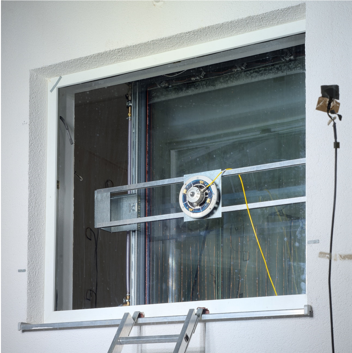
Abbildung 52: Pyranometer vor dem Fluidglaselement. Messung der Einstrahlung auf die Fassade im Modellraumprüfstand (Foto: Heinrich Kleeberger)
