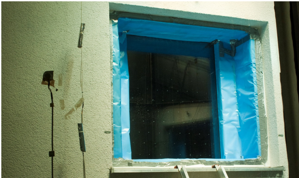
Abbildung 48: Fluidglaselement im Bestandsfensterausschnitt des Modellraumprüfstands von außen betrachtet
