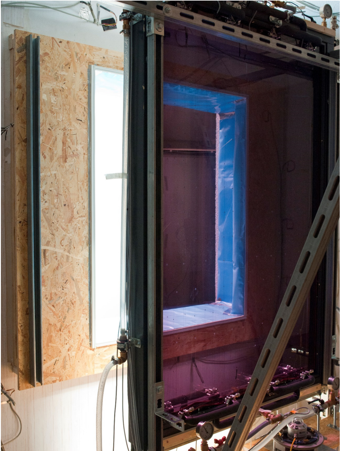
Abbildung 43: Fluidglas-Prototyp mit Einfärbung Basacid® Schwarz X40 im Modellraumprüfstand des Lehrstuhls für Energiewirtschaft und Anwendungstechnik der TUM
