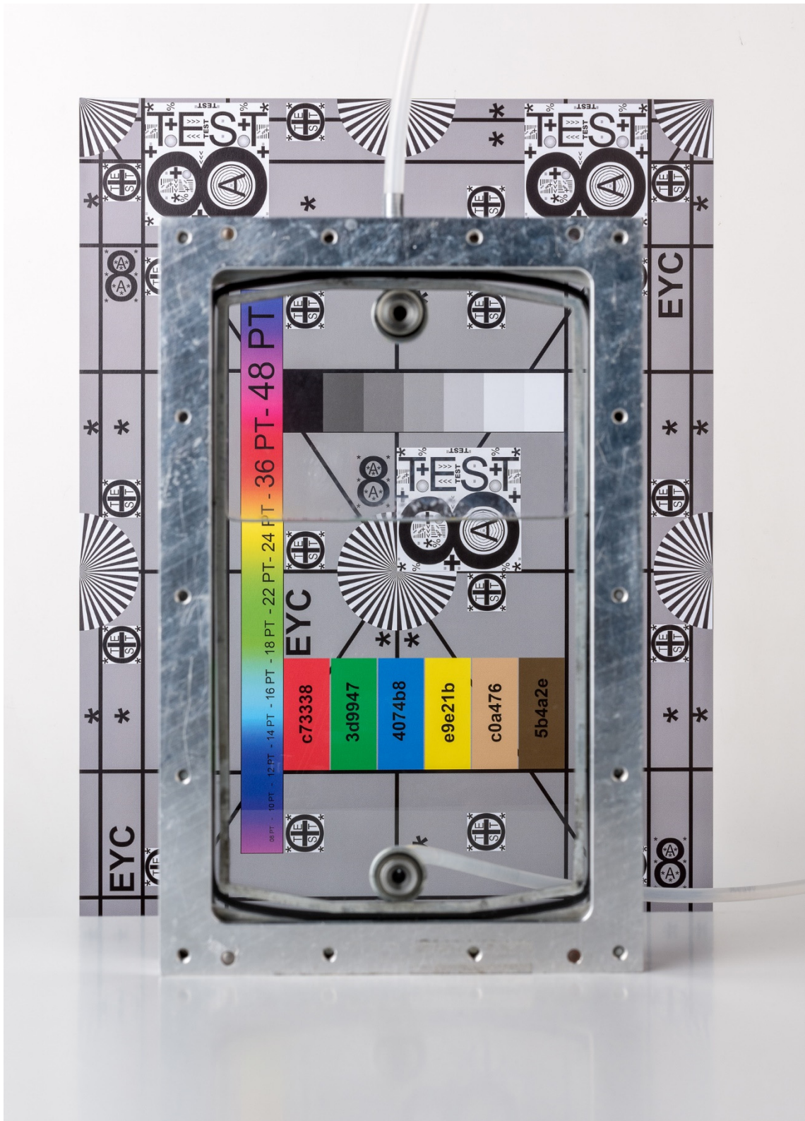
Abbildung 83: Fluidglasprototyp zur Hälfte mit klarem Wasser befüllt; Frontaufnahme (Foto: Astrid Eckert)
