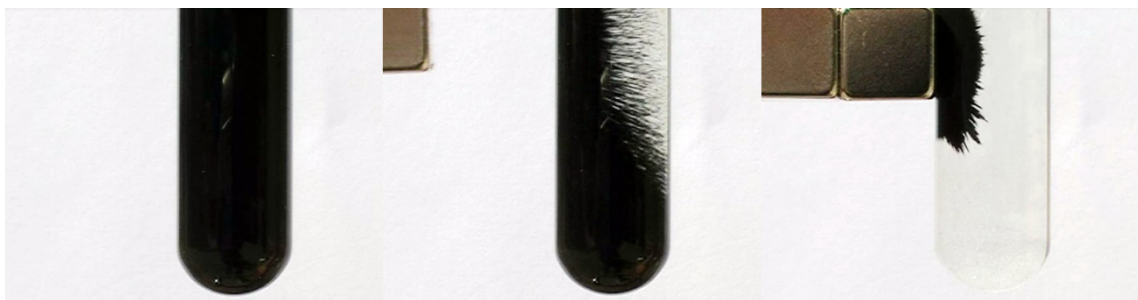
Abbildung 46: Dreistufige Bildfolge des Entfärbungsprozesses eines klaren Fluids mit Eisenoxidpigmenten durch Anlegen eines Permanentmagneten
