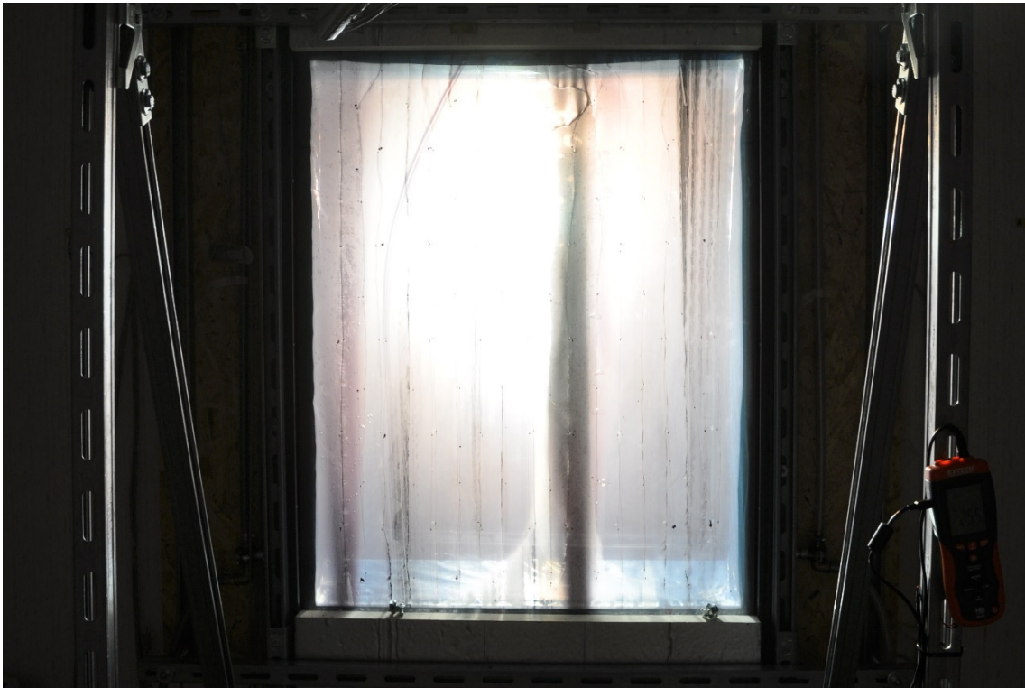
Abbildung 57: Fluidglas mit eingefärbtem inneren Fluidglaskreislauf (F2) im Modellraumprüfstand
