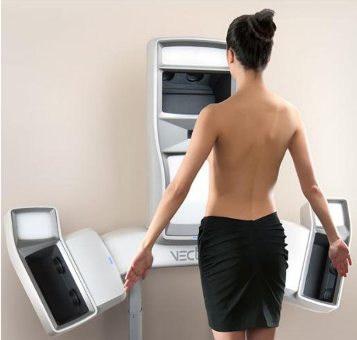
Abb. 9: Vectra XT® von Canfield Scientific, Inc.(R), NJ, USA. Patientin steht vor dem System. Es werden Aufnahmen aus verschiedenen Winkeln erstellt, welche zu einem dreidimensionalen Modell zusammengefügt werden können.
