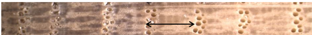
Abb. 4.1: Mikroskopisches Bild eines Bohrkerns in 100-facher Vergrößerung (die Jahringgrenzen sind durch die Ringporigkeit gut zu erkennen und mit einem Pfeil gekennzeichnet).
