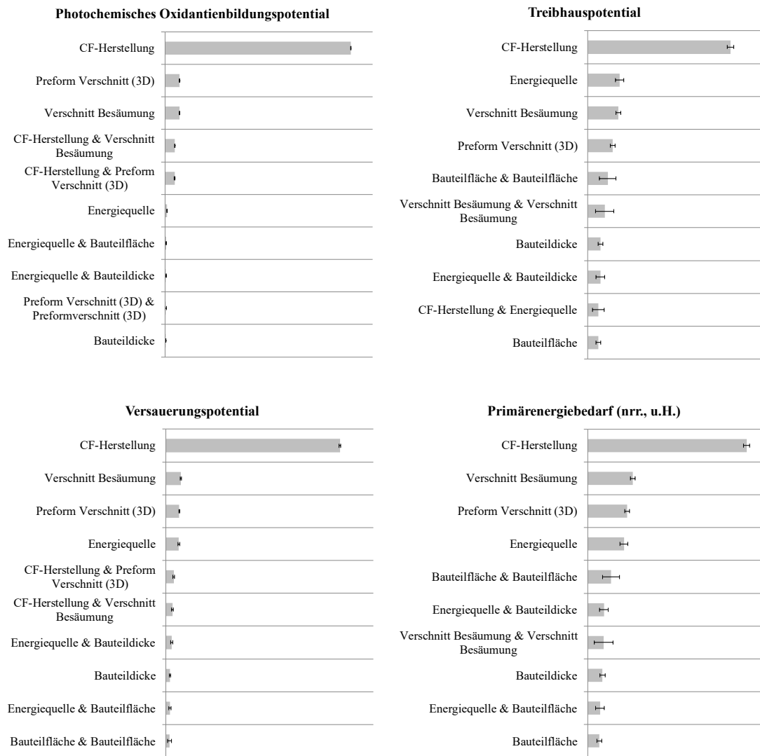
Abb. A-1: Detailanalyse verschnittarmer duroplastischer CFK-Fertigungsprozesskette – Effekte der Produktionsparameter auf die Umweltwirkung
