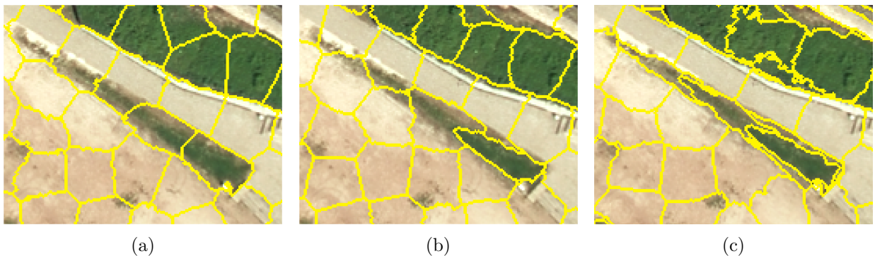
Abbildung 6.13: Vergleich der Segmentierungsergebnisse von drei verschiedenen Distanzmaßen des SLIC-Algorithmus. Original euklidisches Distanzmaß (a), spektraler Winkel mit drei Kanälen (b) und spektraler Winkel mit allen vier verfügbaren Kanälen (c).
