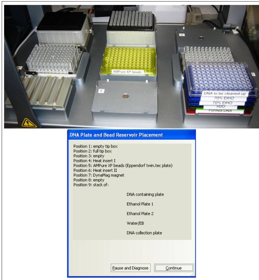
Abbildung 31: Aufbau der Bravo-Oberfläche zur AMPure XP Bead -Aufreinigung. Eine Abfrage und Kontrolle der Positionen erfolgt vor dem Start des Protokolls durch die Software.
