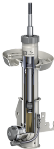
Abbildung 2.6: Schnittdarstellung eines Sachs CDC Dämpfers mit außenliegendem Proportionalventil [45]
