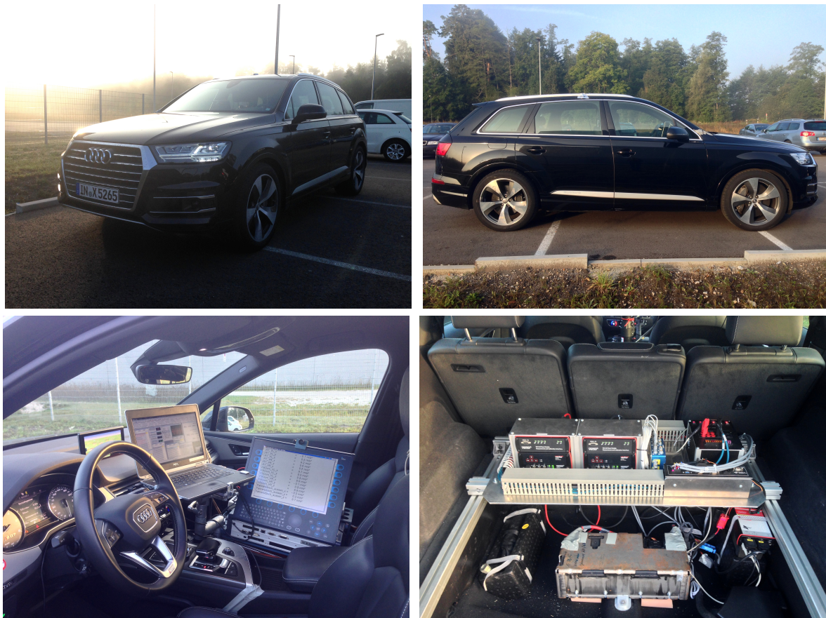
Abbildung 3.5: Verwendeter Versuchsträger AUDI SQ7 (AU536) und verbaute Messtechnik mit Messrechner und Bypassing-Hardware
