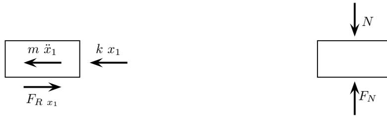
**Abbildung 3.3:** Gleichgewicht in  $x_1$ -Richtung (links) und in  $x_2$ -Richtung (rechts)
