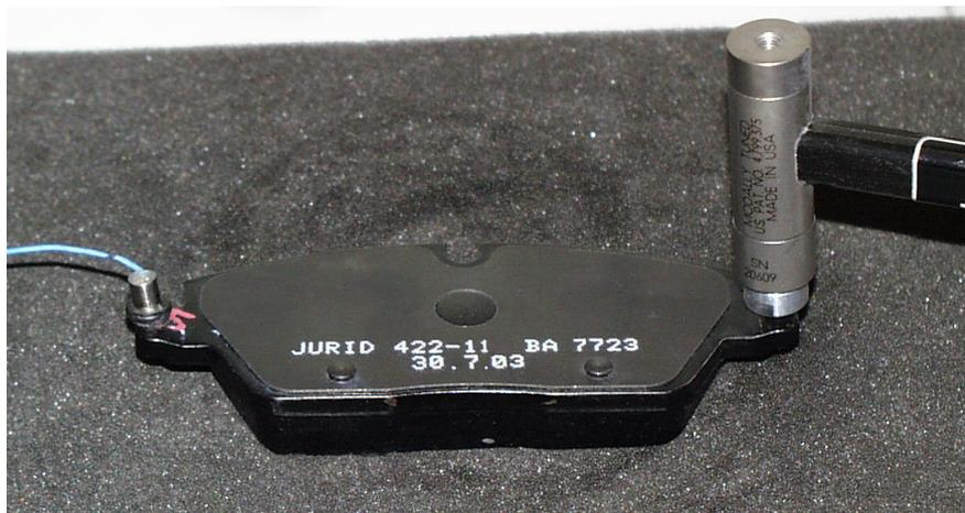
**Abbildung 5.2:** Hammerschlagversuch zur Modalanalyse bzw. Eigenfrequenzmessung an einem Bremsbelag, aus Tobón [2011]
