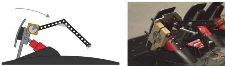
Abbildung 16: Gaspedal mit Widerstand: links – Prototyp, rechts – Umsetzung
