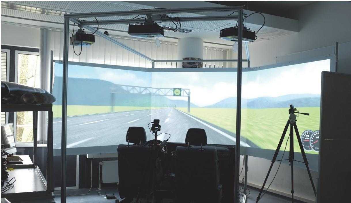
Abbildung 52: Aufbau der Versuchsumgebung: Fahrsimulator
