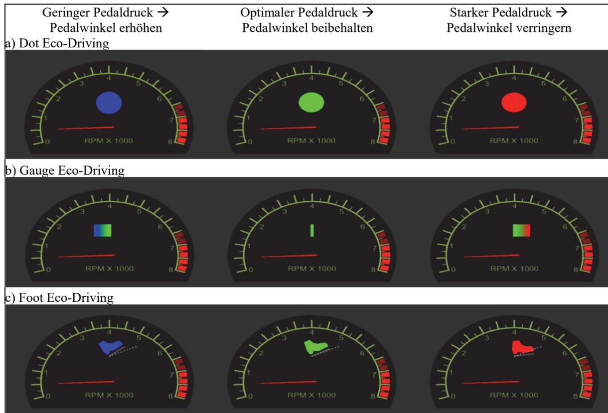
Abbildung 11: Eco-Driving Anzeigen: a) Dot, b) Gauge und c) Foot
