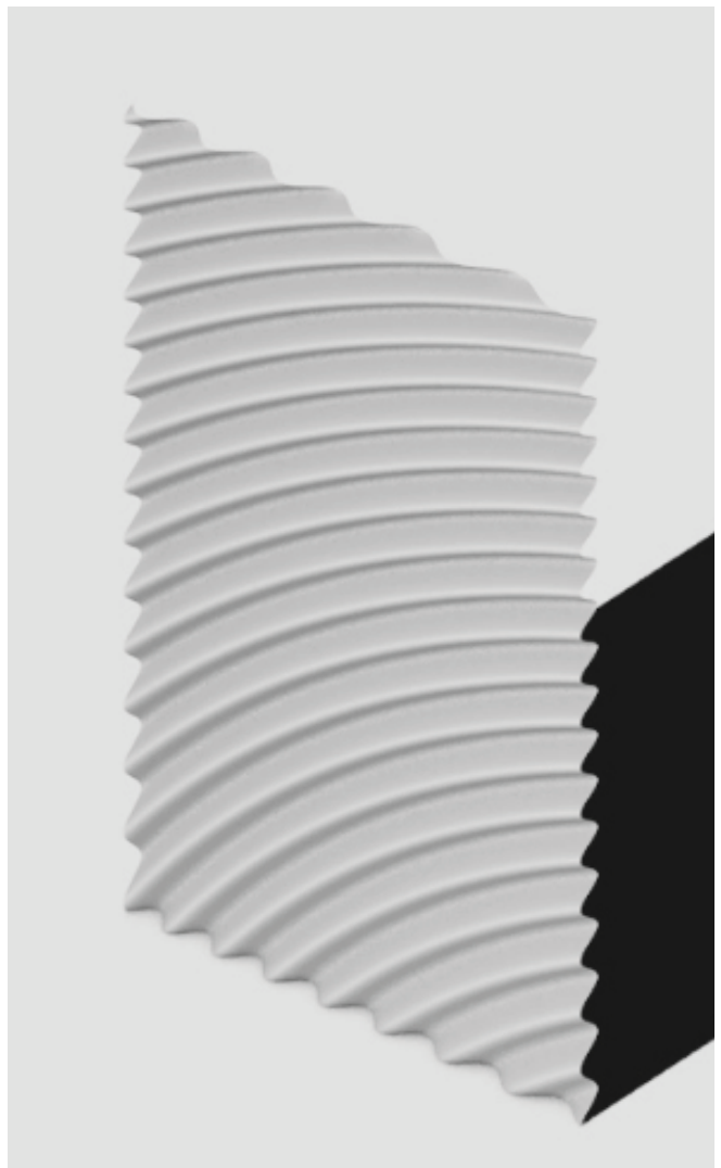
[Abb. 9.5.1_8] Sonnenstandssimulation Auszug 21.12. 13:00 Uhr Standort: Solarstation TUM Funktion: Ertrag von solarer Strahlung im Winter
