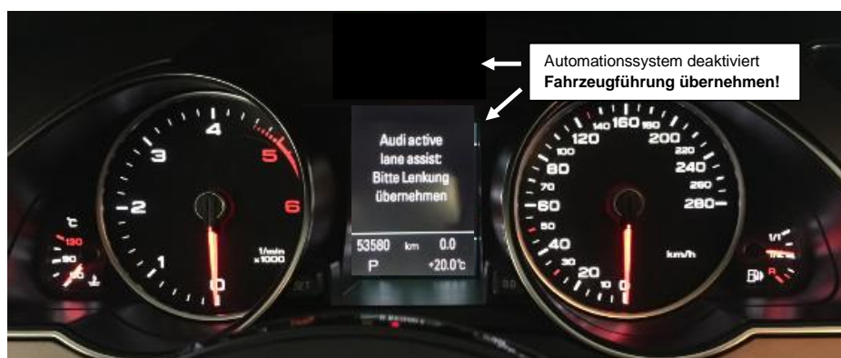
Abbildung 2: Übernahmeaufforderung, Kombi-Instrument des Audi A5 Prototyps
