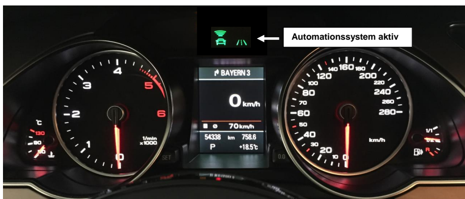
Abbildung 1: Aktiviertes Automationssystem, Kombi-Instrument des Audi A5 Prototyps
