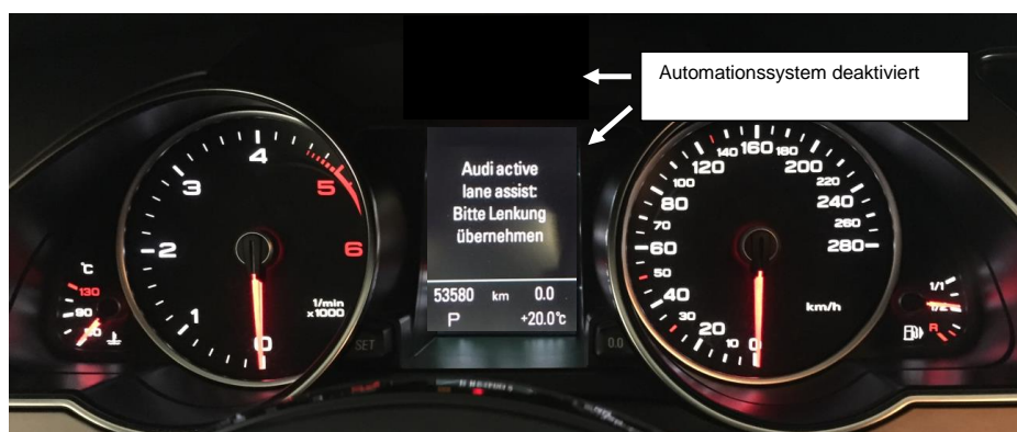
Abbildung 2: Übernahmeaufforderung, Kombi-Instrument des Audi A5 Prototyps
