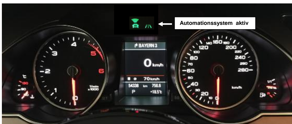
Abbildung 1: Aktiviertes Automationssystem, Kombi-Instrument des Audi A5 Prototyps
