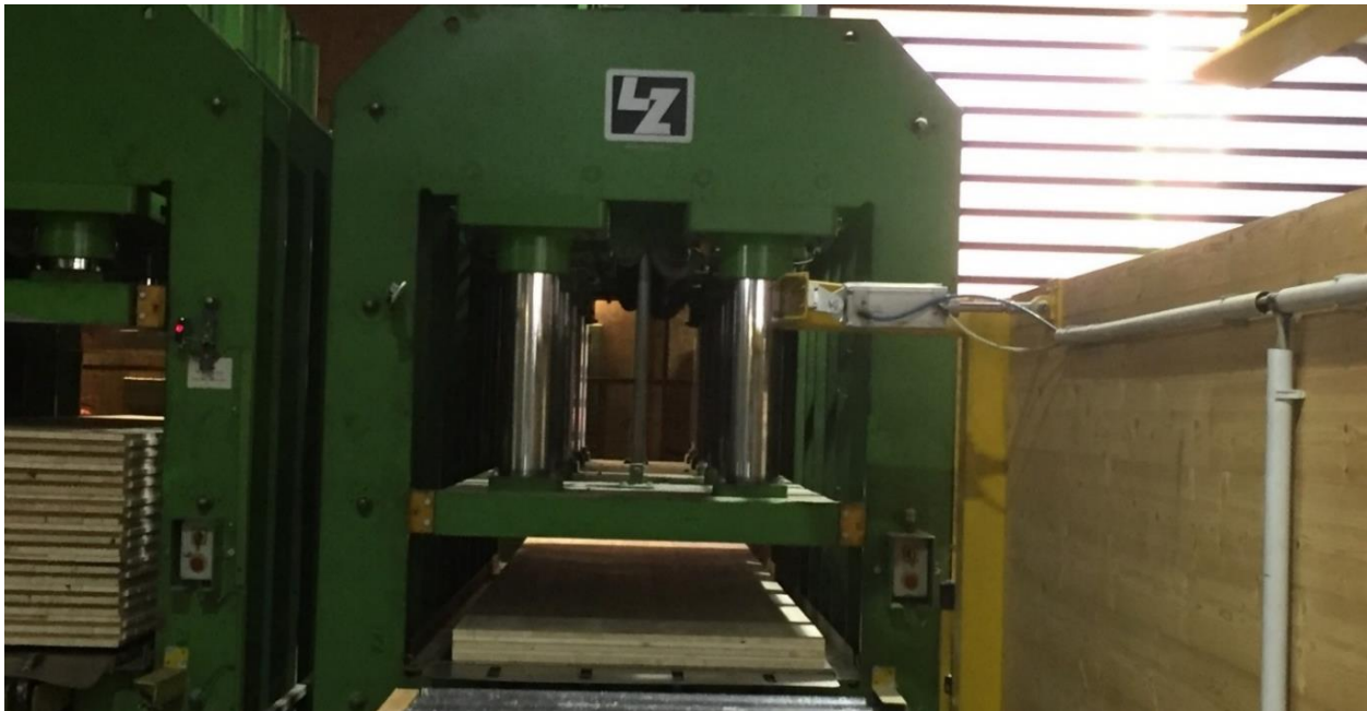
Abbildung 4.9: Verpressen und Aushärten der Halbelemente im hydraulischen Pressbett
