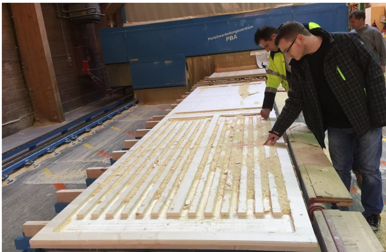
Abbildung 4.6: Das Fräsen der Kanäle in Schicht zwei hat auch quer zur Faserrichtung dort problemlos funktioniert, wo die Lamellen schmalseitenverklebt sind
