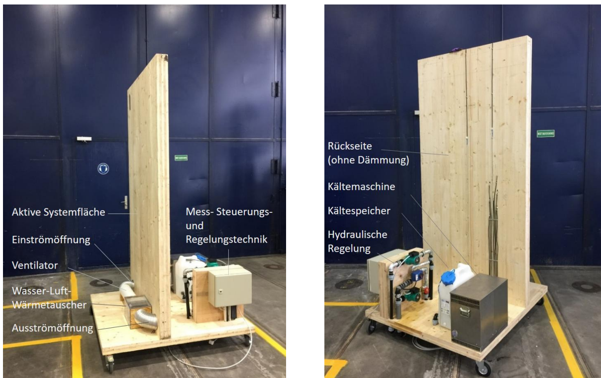
Abbildung 4.19: Mobile Versuchskonfiguration Prototyp A; links: Vorderansicht, rechts: Rückansicht
