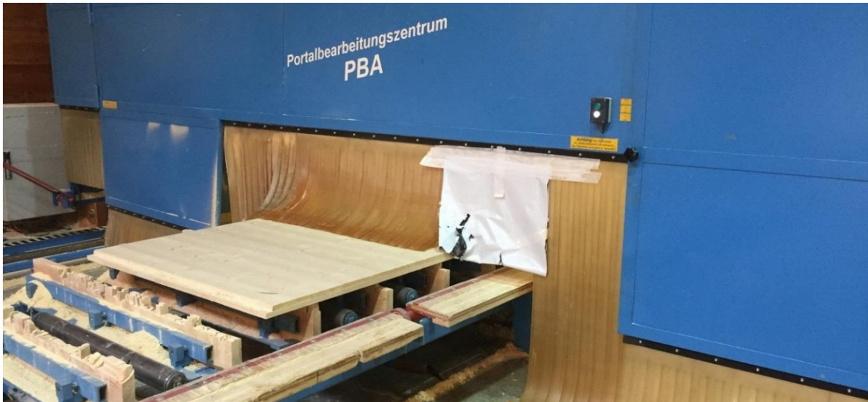
Abbildung 4.3: Vor dem Abbund durch das Portalbearbeitungszentrum wird das Halbelement auf dem Werkstückträger ausgerichtet, fixiert und geometrisch über einen Laser referenziert
