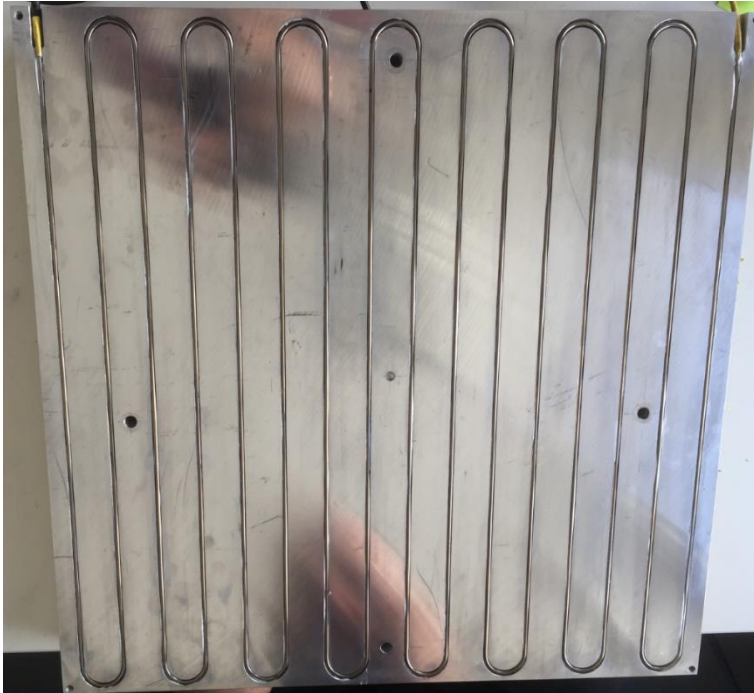
Abbildung 11.2: Aluminium-Heizplatte mit rückseitig eingefrästen Nuten und eingelegtem Heizdraht mit einer gesamt Heizleistung von 1100 W
