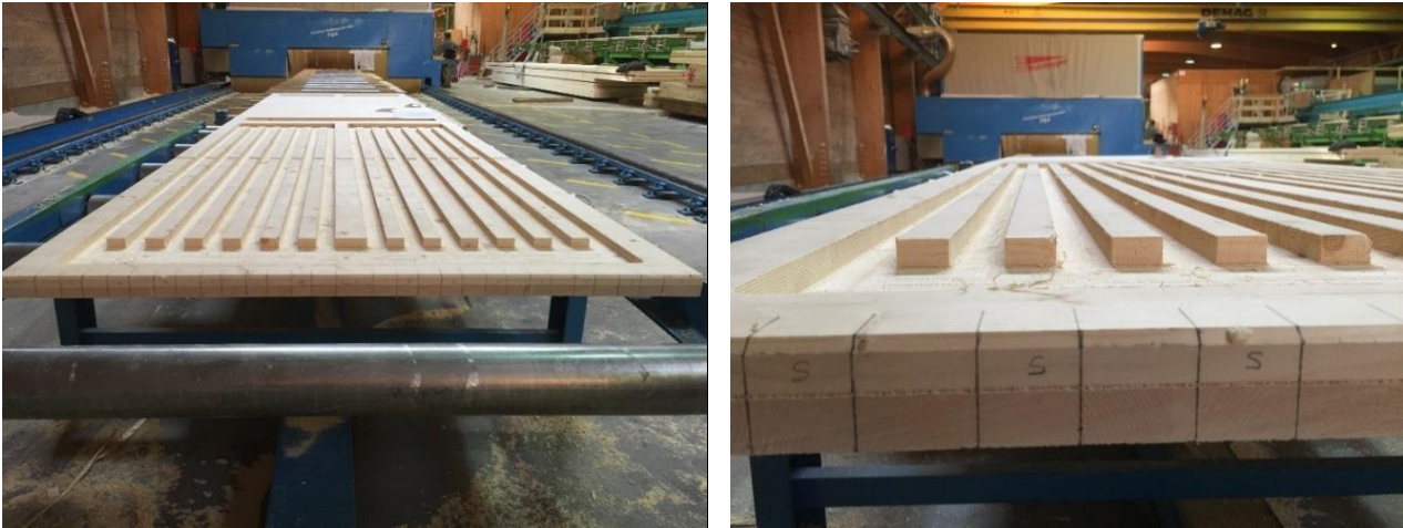
Abbildung 4.11: Zur späteren Positionierung der Messsensoren wurden die Stege stirnseitig markiert
