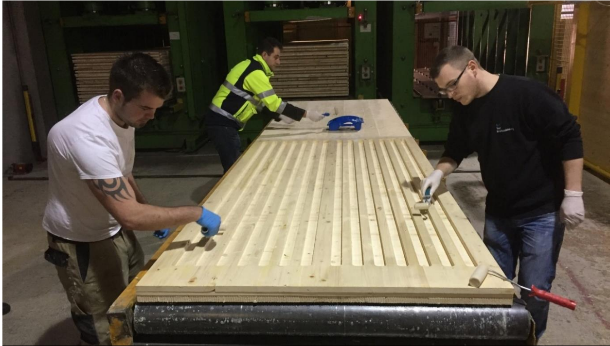
Abbildung 4.7: Der Auftrag des Klebers erfolgt manuell auf das rückseitige Halbelement
