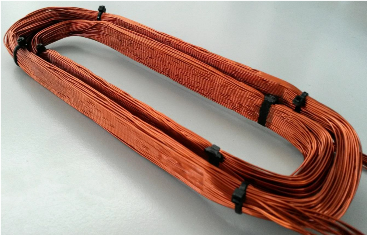
Abbildung 5-20: Verbackene Spule (nach Serkyov, 2015)
