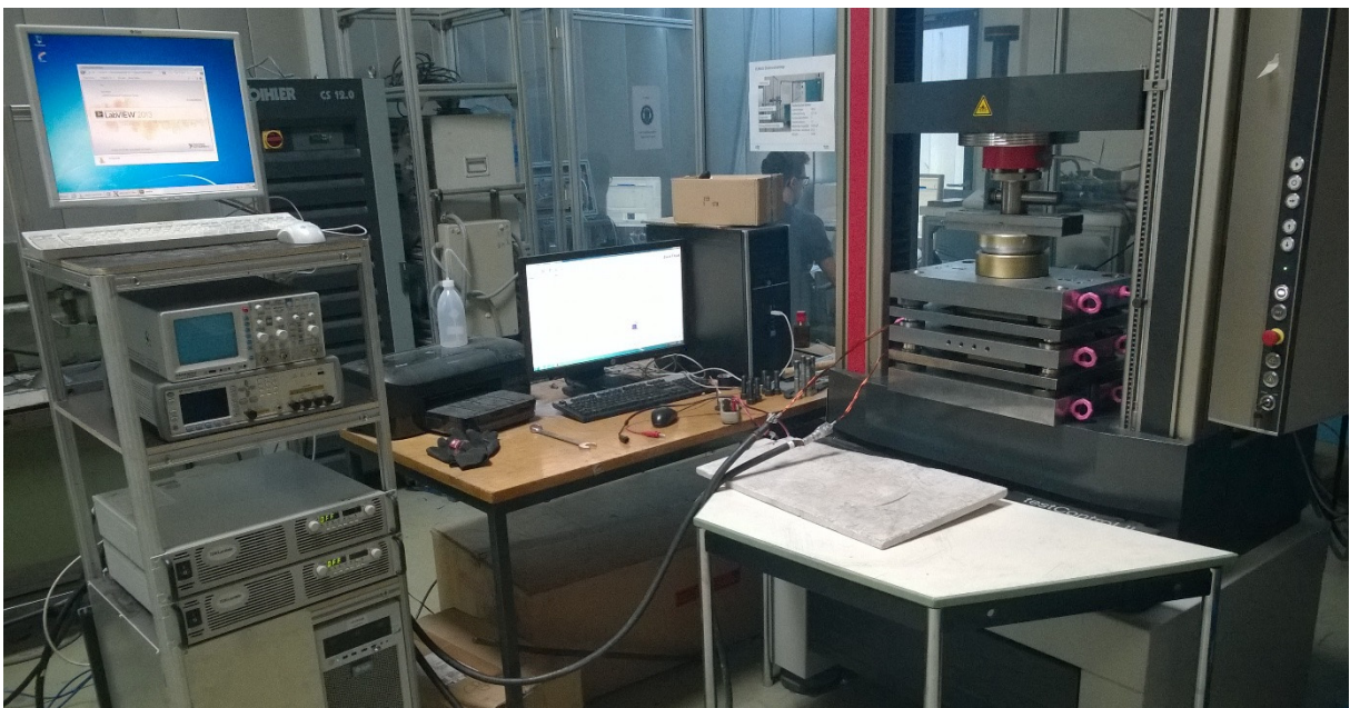
Abbildung 5-17: Versuchsaufbau mit Heizvorrichtung und Universalprüfmaschine
