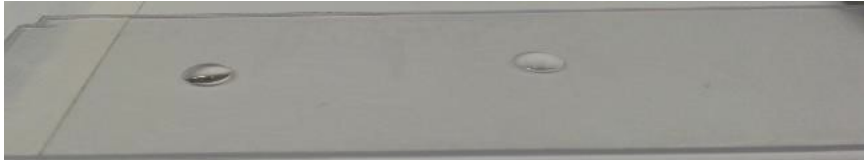
Abbildung 38: Benetzbarkeit von unbeschichtetem (A) und mit modifiziertem Jeffamine® ED-2003 beschichtetem PC (B).
