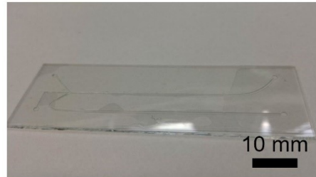
Abbildung 21: Verklebung von lasergeschnittenen Kanälen in PMMA mit Glas durch UV-Kleber Best PL 5141 (A) und Best PL 5373 (B).
