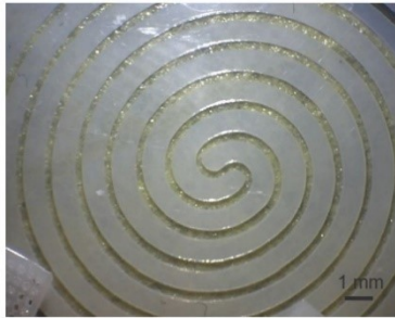
Abbildung 22: Spiralstruktur in 125 µm dickem PET, geschnitten mit digitalem Schneideplotter (A). Übergang von Kanal zu Reservoir-Struktur zum Anschließen von einem Schlauch in 130 µm dickem Polystyrol (B).
