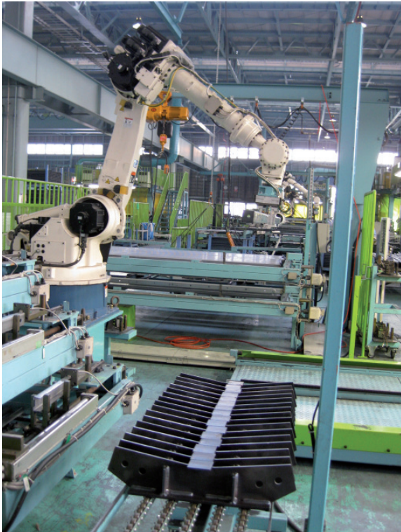
Bild 3. Die Firma „Sekisui House“ bietet Häuser an, die aus vorgefertigten Stahlpaneelen hergestellt sind. Diese werden von Robotern sehr präzise zusammengesetzt und -geschweißt. Durch die hohe Qualität erreicht das Gebäude hohe Erdbbensicherheit [3]. © T. Linner/ T. Bock
