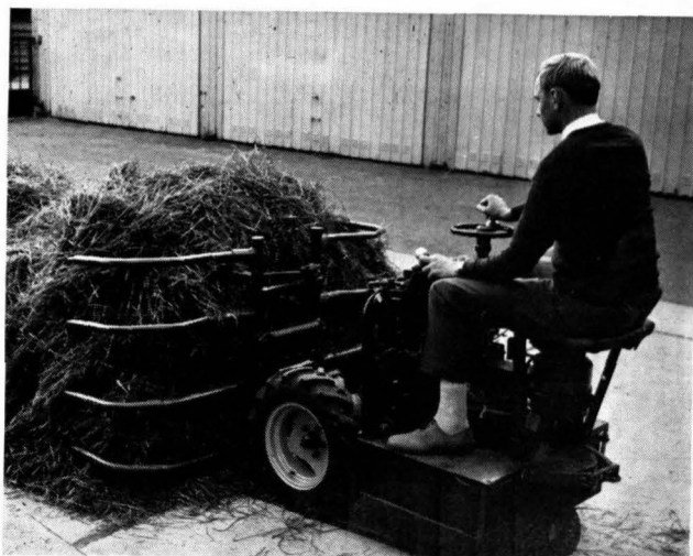
Abb. 8: Prototyp eines elektrogetriebenen Universal-Motorgerätes für Hoftransporte, hier ausgerüstet mit Greifzangen
