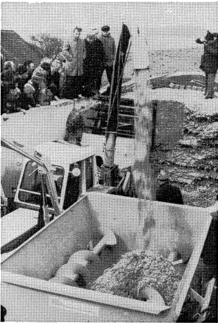
Abb. 2: Futtermischwagen und Flachsilofräse haben in vielen Betrieben die körperlich schwere Arbeit der Fütterung übernommen
