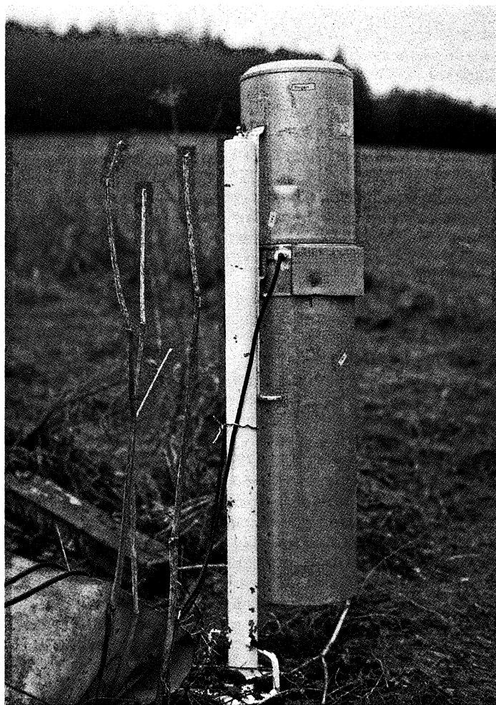
Der Regenmesser ist eine absolute Neuentwicklung aus Weißenstephan, der völlig wartungsfrei arbeitet.
