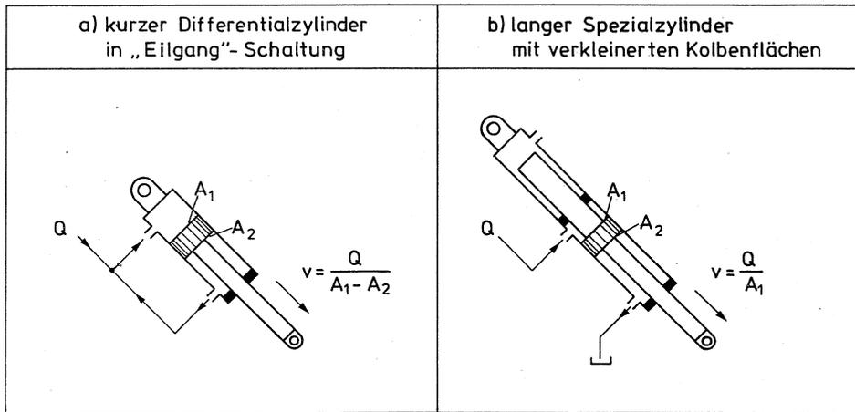
Abb. 4: Doppeltwirkende Hydraulikzylinder für die Werkzeugbetätigung mit schneller Ausfahrgeschwindigkeit
