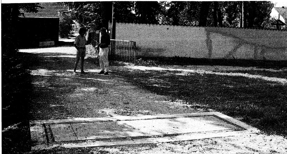
Der Wägeteppich der Achslastwaage läßt sich gut im Einfahrtbereich integrieren.
