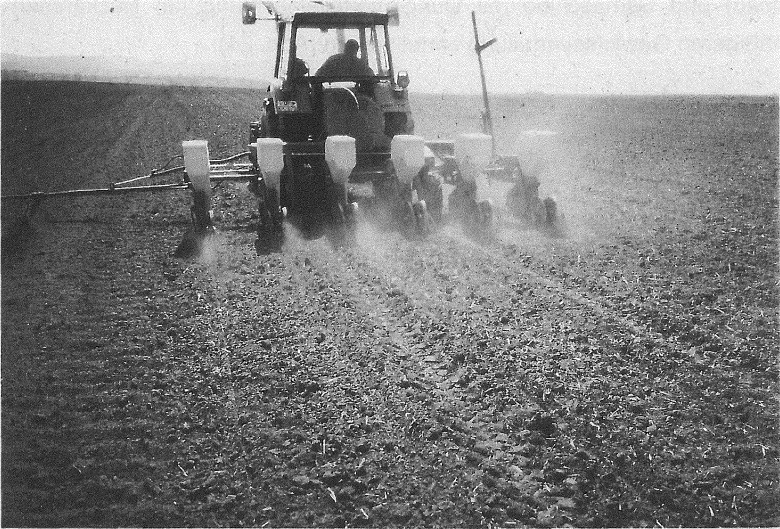
Abb. 22: Teleskop-Schieberahmen bei Einzelkornsägerät Maxem der Fa. Rau
