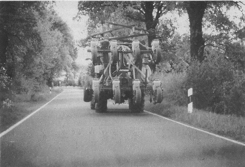
Abb. 23: Eingeschwenkte Säaggregate für Transportstellung
